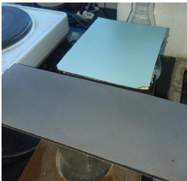
Figura 36 - Resultado do teste de resistência ao calor aos provetes 02-14 (observa-se em primeiro plano) e 02-15.
