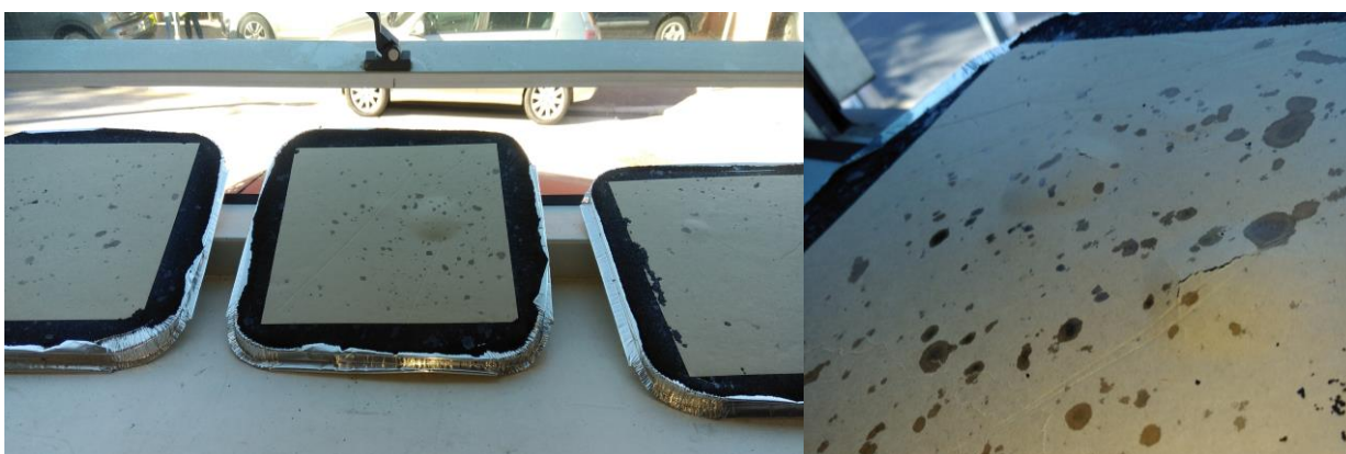
Figura 25 - Defeitos superficiais associados ao arrefecimento do core fora da prensa à temperatura ambiente.
