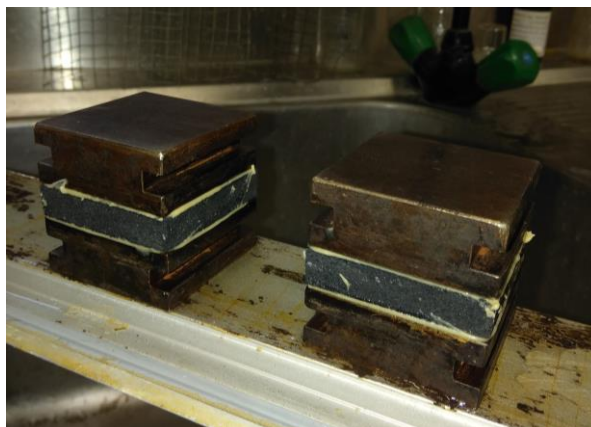
Figura 17 - Detalhe da interface provete-superfície metálica.
