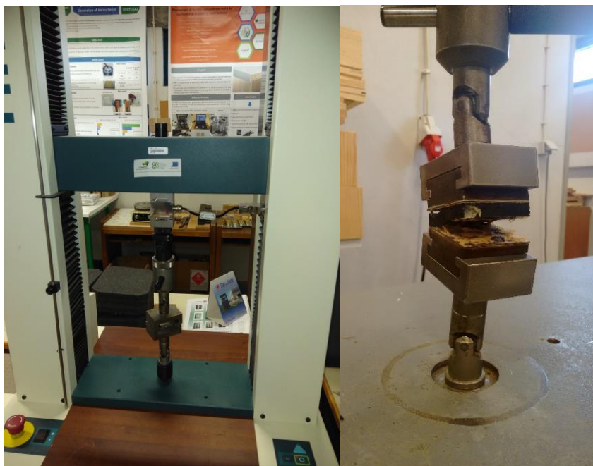
Figura 18 - Detalhe do equipamento e ensaio numa fase final.
