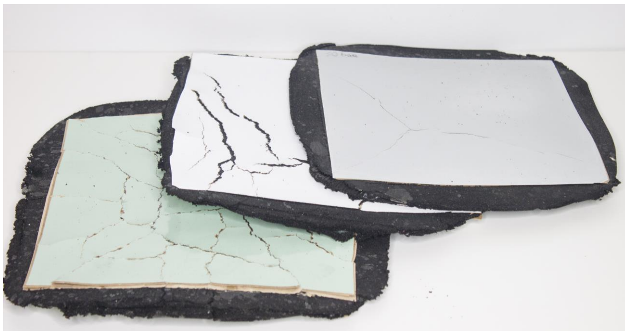
Figura 31 - Fissuras nos compactos em ensaios com diferentes decorativos.
