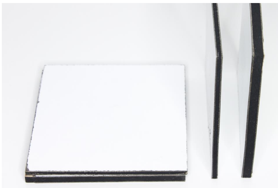
Figura 20 - Compactos de borracha produzidos nas condições otimizadas do estudo anterior deste projeto (dois com 5 mm e dois com 12,5 mm de espessura, 4% resina).
