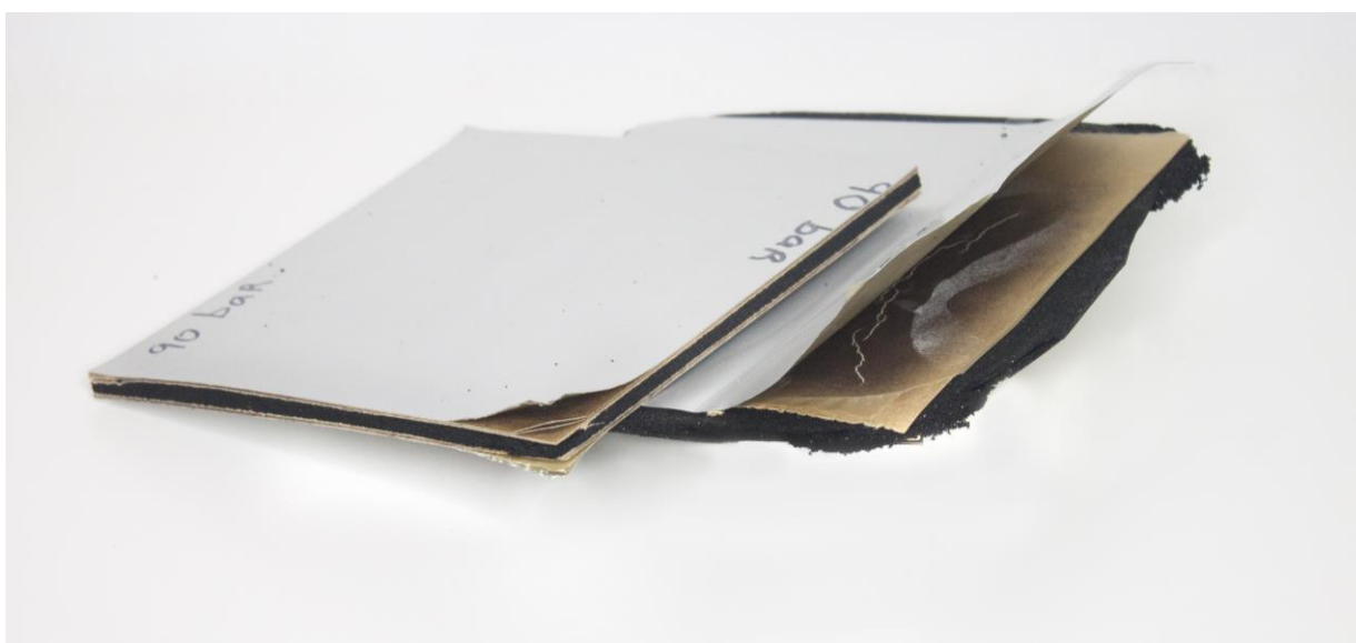
Figura 30 - Resultado dos ensaios com decorativos metalite e alumínio.
