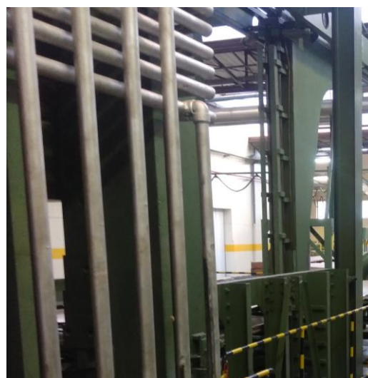
Figura 8 - Prensa 1 de alta pressão da SIR (1959) Dimensões: 2,5 m x 1,25 m; Pressão \geq 9 MPa
