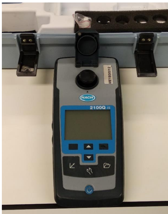
Figura 13 - Medição de turvação usando o turbidímetro portátil Hach 2100Q IS.
