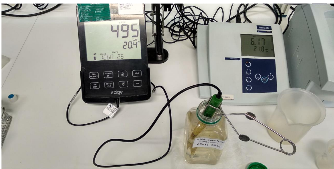
Figura 7 - Determinação analítica de condutividade de uma amostra composta de efluente.
