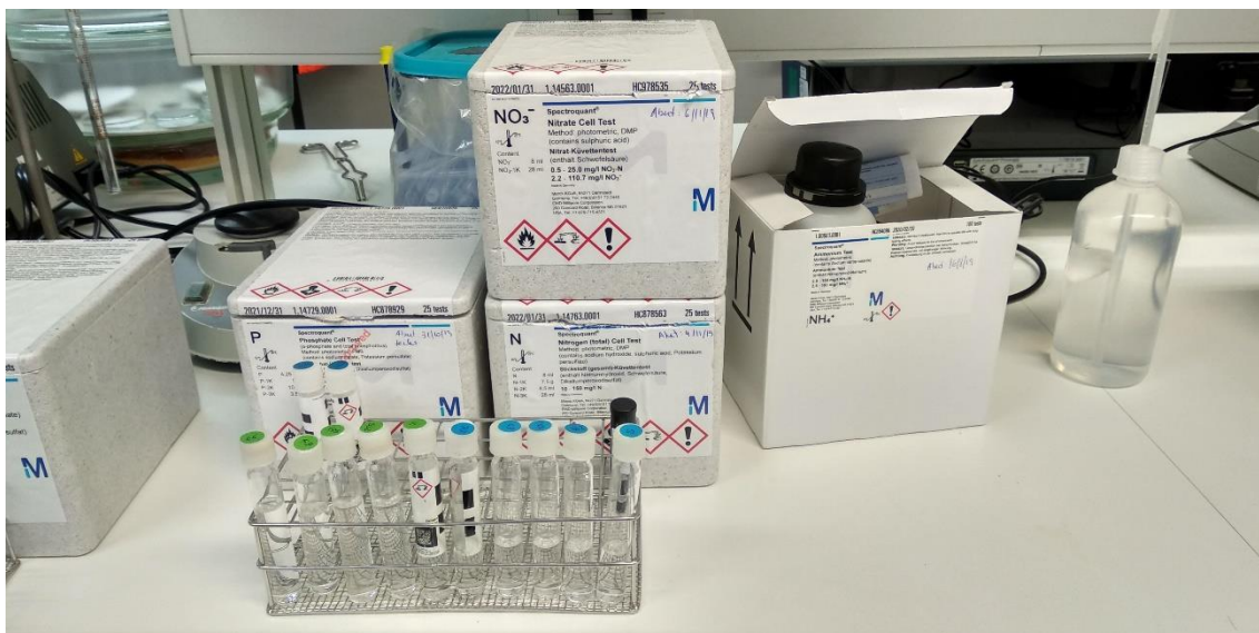
Figura 12 - Preparação de cuvetes de reação dos kits de Azoto Total, Fósforo Total e Nitratos.
