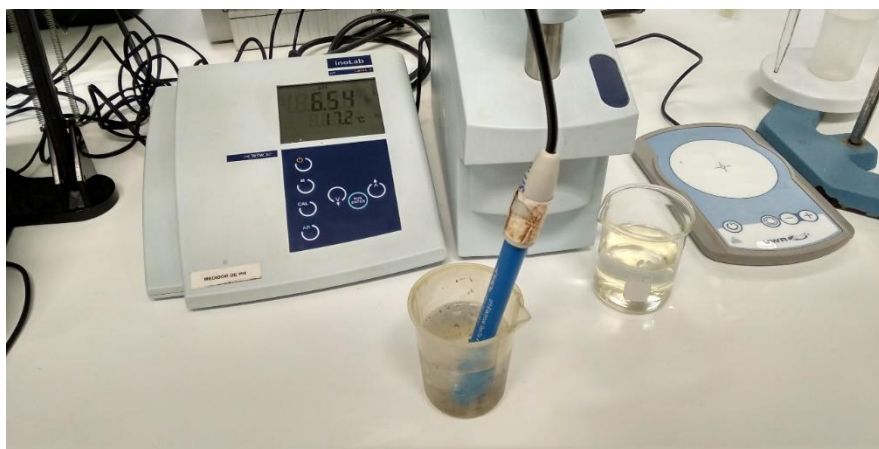
Figura 6 - Determinação analítica do pH de uma amostra de afluente pelo método potenciométrico.
