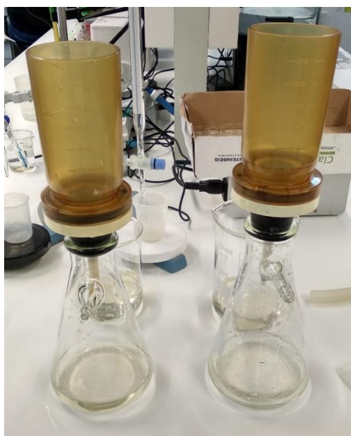
Figura 17 - Ensaios de filtração com filtros microtamisadores à escala piloto.
