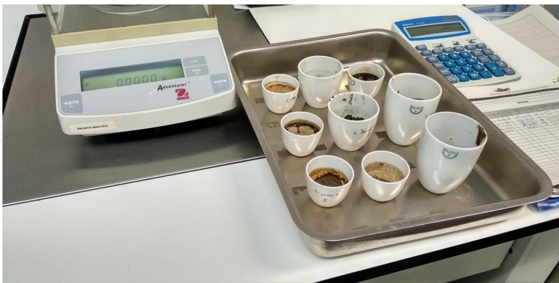
Figura 9 - Pesagem de cadinhos com peso seco para a determinação de ST, SV, %MS e %MV.
