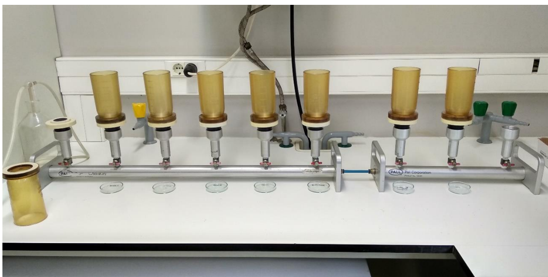
Figura 8 - Rampa de filtração usada na determinação de SST e SSV.
