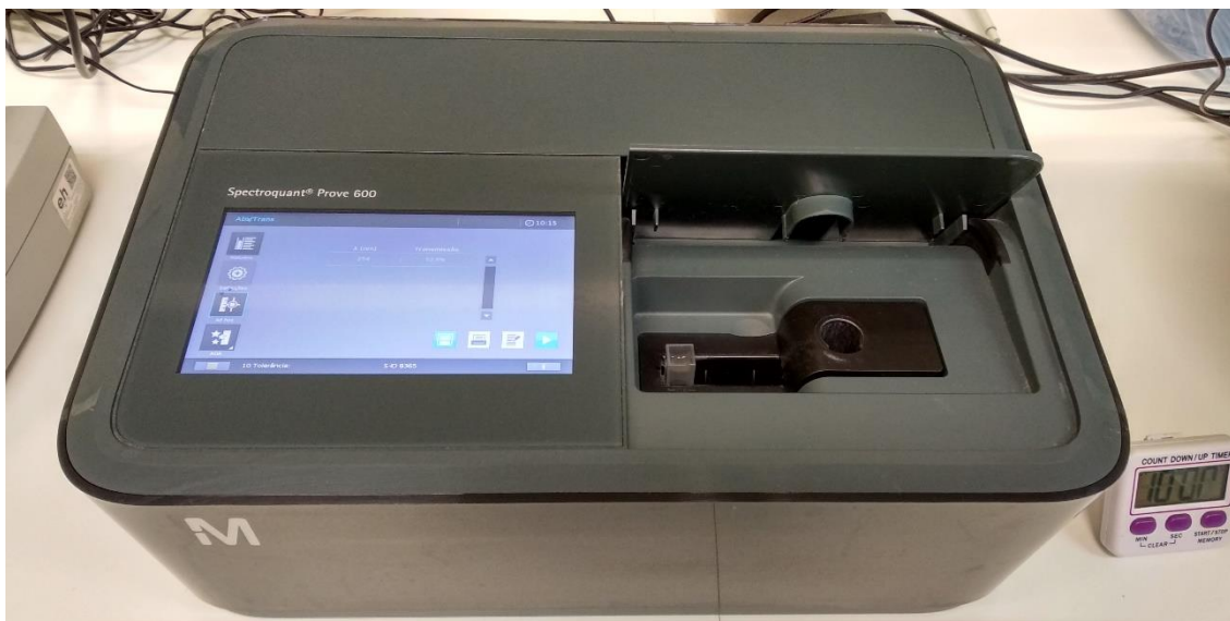
Figura 14 - Medição da transmitância usando o espectrofotómetro Merck Spectroquant® Prove 600.
