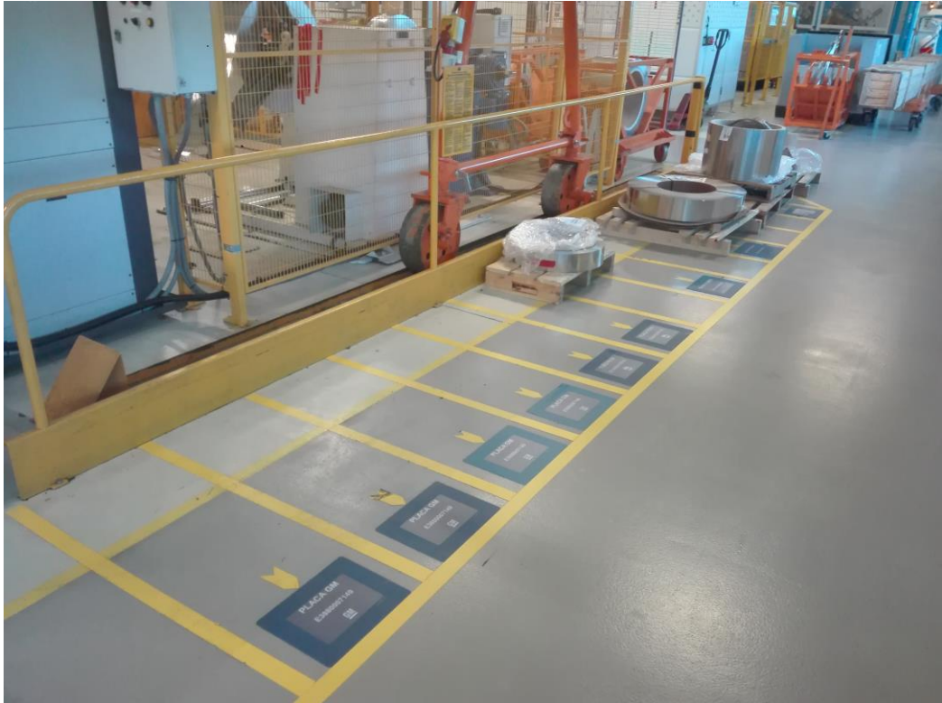
Figura 13 – Local de armazenamento dos tubos ovais e placas onduladas de baixa cadência antes da lavadora
