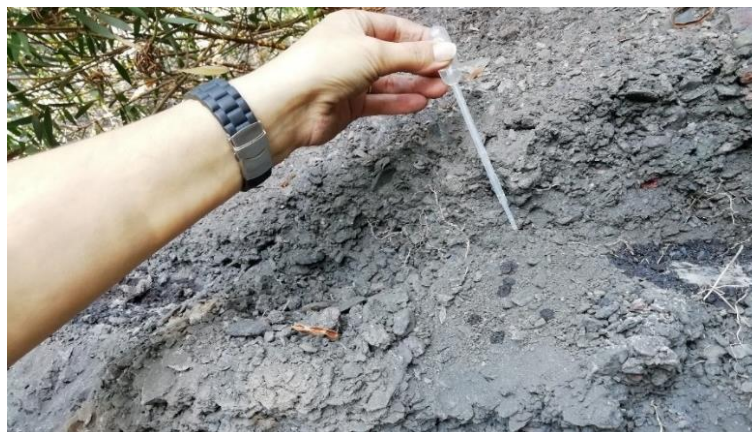
Fig. 51 - Realização do teste de WDPT, utilizando um conta-gotas, na escombreira de SPC.
