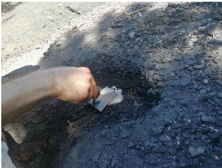
Fig. 27 - Colocação de areia calibrada no local onde o infiltrómetro vai realizar o ensaio.
