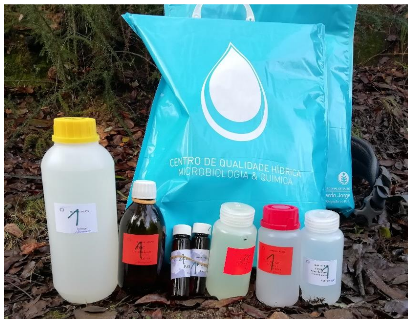
Fig. 19 - Frascos para armazenamento das amostras de água e saco de transporte até o laboratório.
