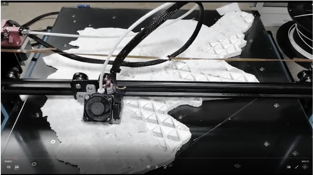
Figura 33 Imagem referente a frame video de impressão FDM de modelo 3D referente ao local de projeto (fonte: autor)
