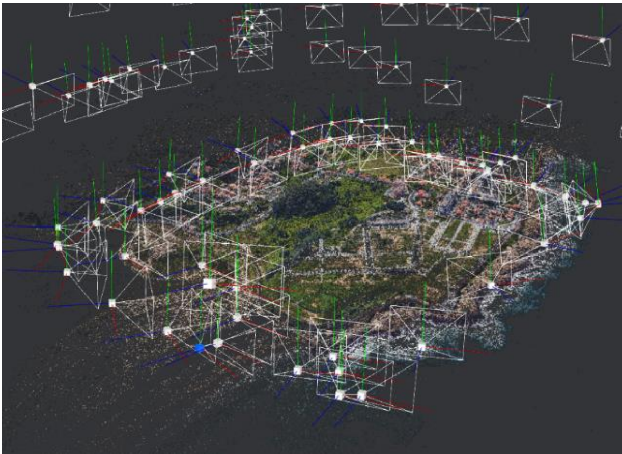
Figura 24 Modelo nuvem de pontos, junto de posicionamento fotográfico (fonte: Meshroom)
