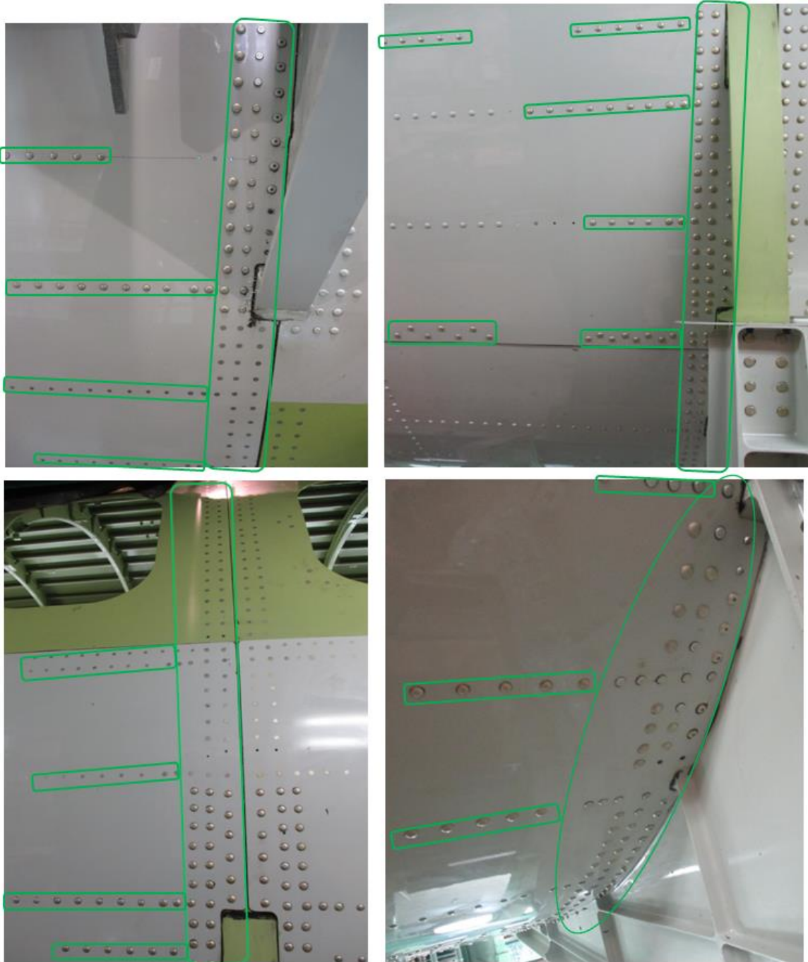
Figura 32 - Alguns rebites da zona exterior antes de serem inspecionados (cortesia da OGMA)
