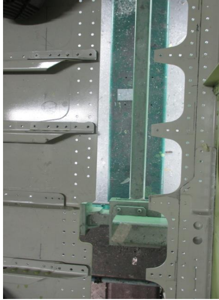
Figura 29 – Fotografia de furos a serem inspecionados no frame 21 (cortesia da OGMA)
