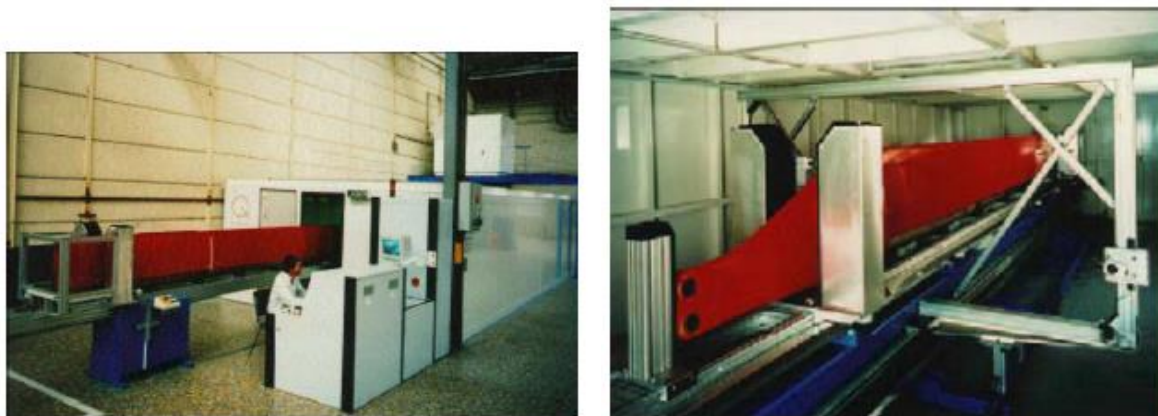
Figura 14 - Na figura da esquerda o sistema de inspeção com o rotor do helicóptero prestes a ser submetido ao teste. Na figura da direita o rotor do helicóptero já dentro do equipamento de xerografia (Cruta e Wall, 2006).
