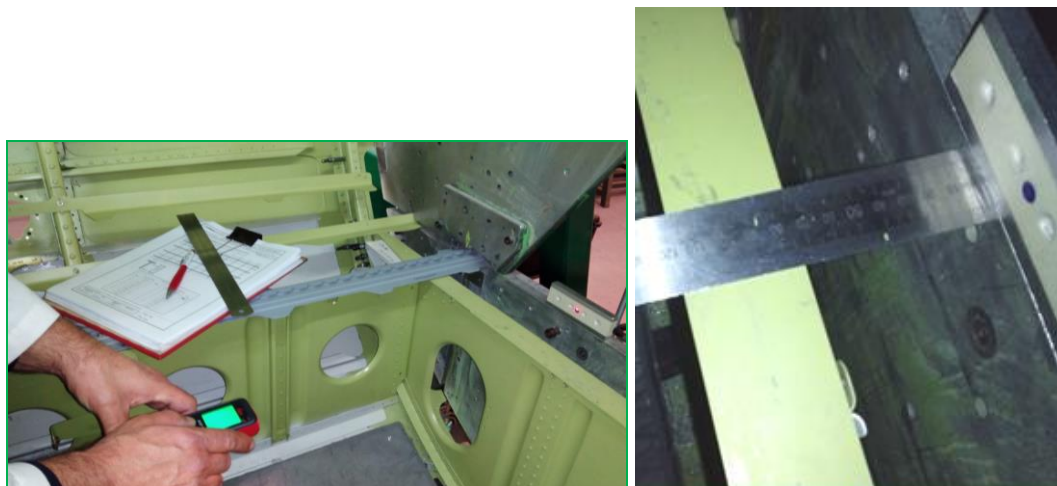
Figura 55 – À esquerda medição com medidor laser e à direita medição do ponto A com régua.
