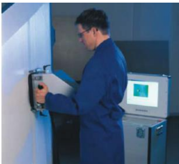
Figura 15 - Sistema portátil que contém uma câmara de shearografia (Krupta e Walz, 2006).
