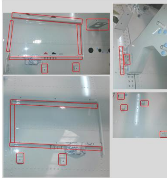
Figura 50 - Fotografias do suporte de AC antes de ser inspecionado (cortesia da OGMA)
