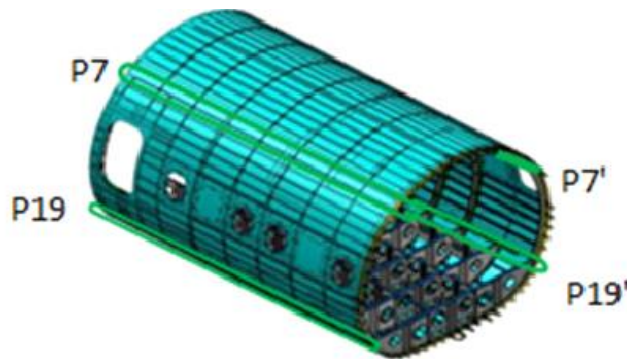
Figura 35 - Esquema da fuselagem desde o frame 13 até o 20.1, com o P7, P7', P19 e P19' evidenciados (cortesia da OGMA)
