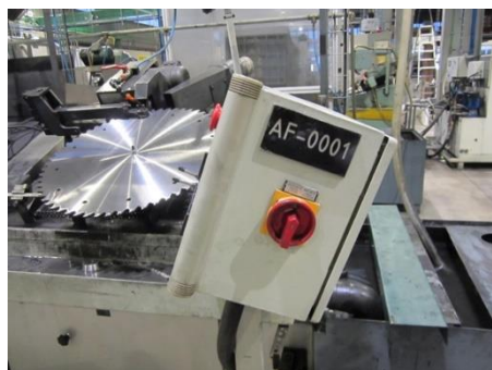
Figura 37 - Placas identificadoras das máquinas.
