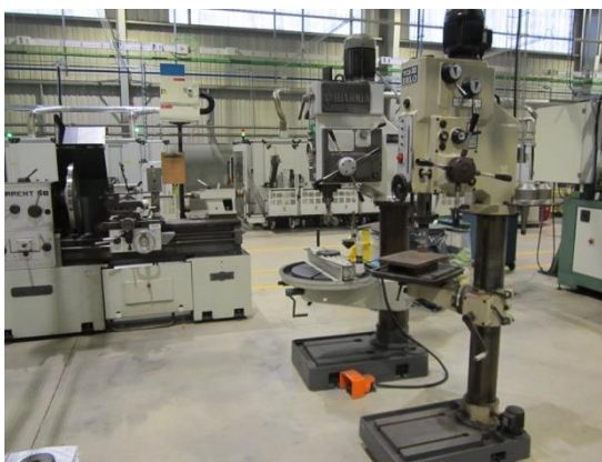
Figura 23 - Do mais longe para o mais perto: Torno, Lixadora e Escareadora de Furos do Torno.
