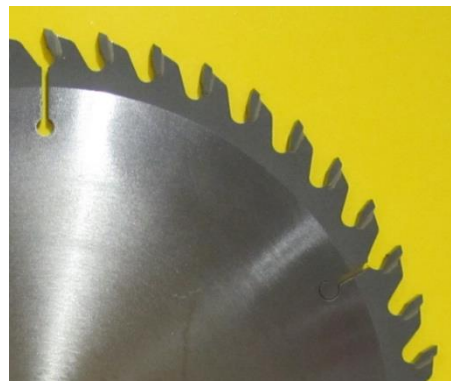
Figura 29 - Serra após a Decapagem.
