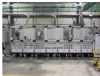
Figura 33 - Trem de Afiamento Automático.
