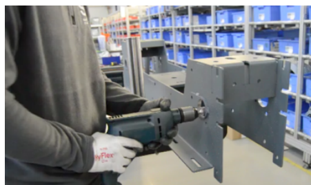
Figura 16: Retificação do furo da arcada
