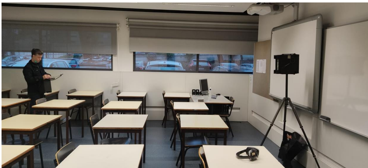
Figura 4.26 – Medição do RASTI na sala a1.10 da Escola Secundária de Gondomar [foto do autor].
