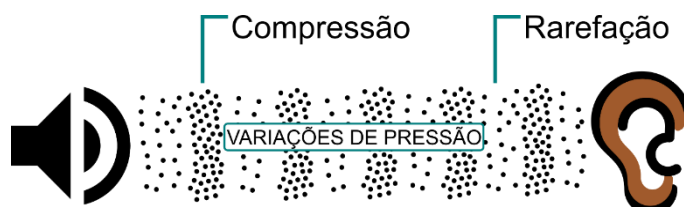
Figura 2.1 - Exemplo de propagação do som (Adaptado de [2]).
