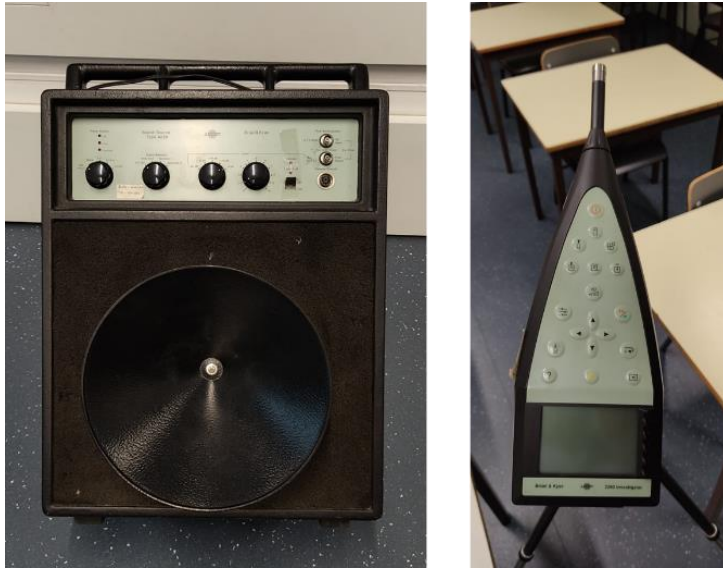
Figura 4.20 – Fonte sonora Brüel & Kjaer 4224 à esquerda e sonómetro Brüel & Kjaer 2260 à direita [foto do autor].
