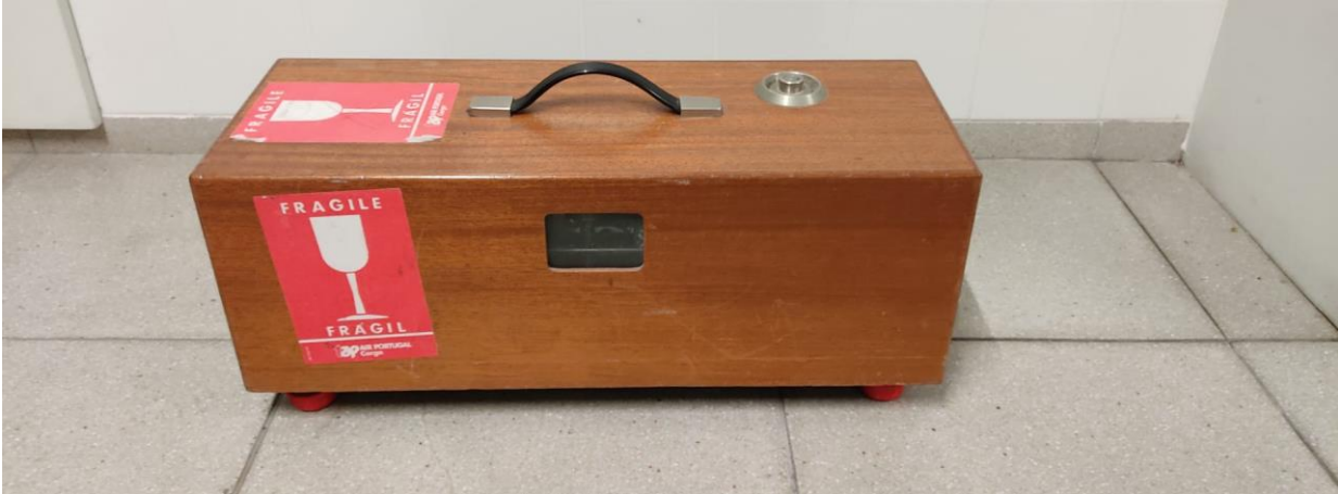
Figura 4.24 – Máquina de impactos normalizado Brüel & Kjaer 3204 [foto do autor].
