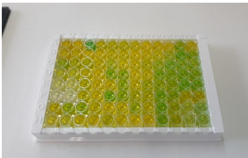
Figura 10 - Resultado de um dos testes ELISA para extrair o cortisol das amostras de pelo de lobo
