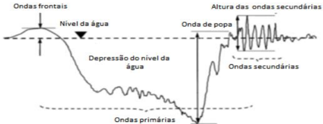
Figura 3.7. Representação das ondas primárias e secundárias (adaptado de Gomes, 2014)
