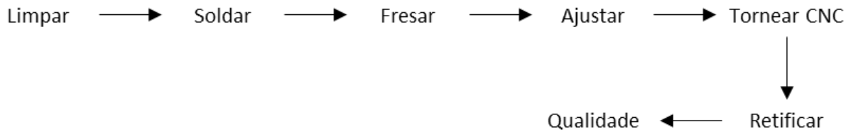
Figura 12 - Fluxo de moldes prensado-soprado dentro da Moldin
