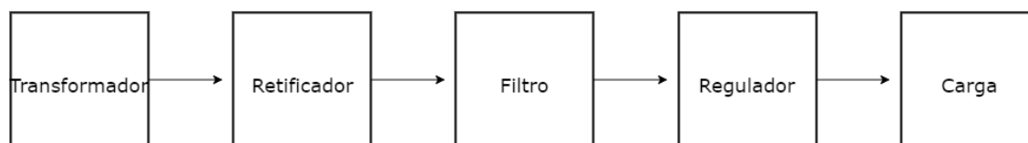
Figura 1 - Diagrama de blocos da fonte de alimentação linear
