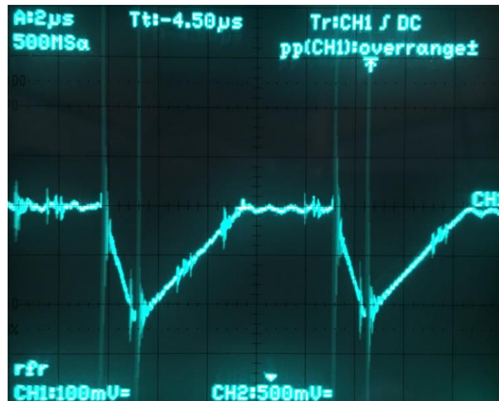
Figura 87 - Corrente inversa na bobine do PFC para 220 VAC em meia carga
