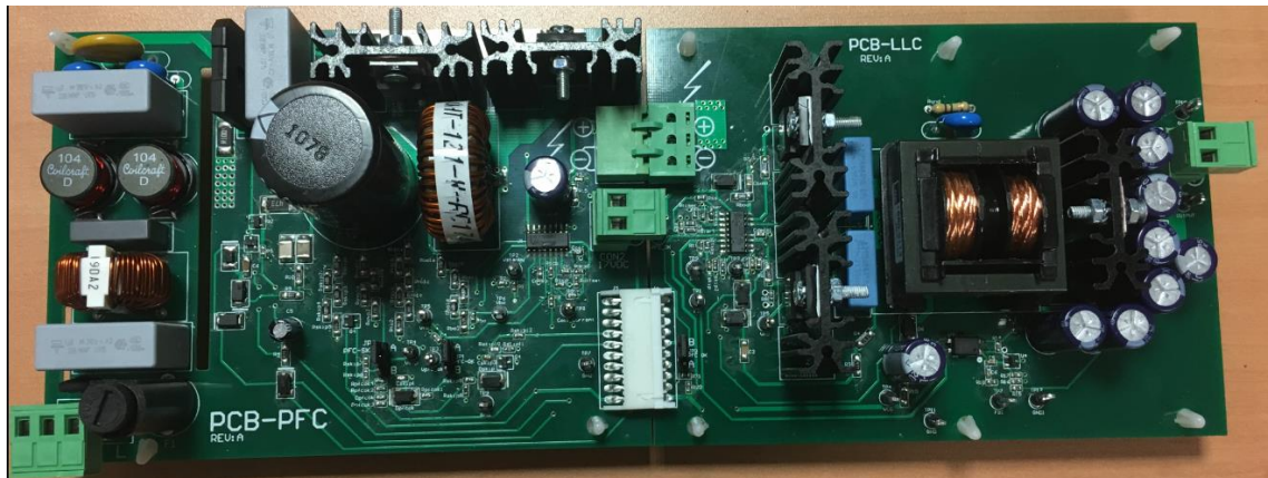
Figura 75 - Fotografia da fonte de alimentação projetada
