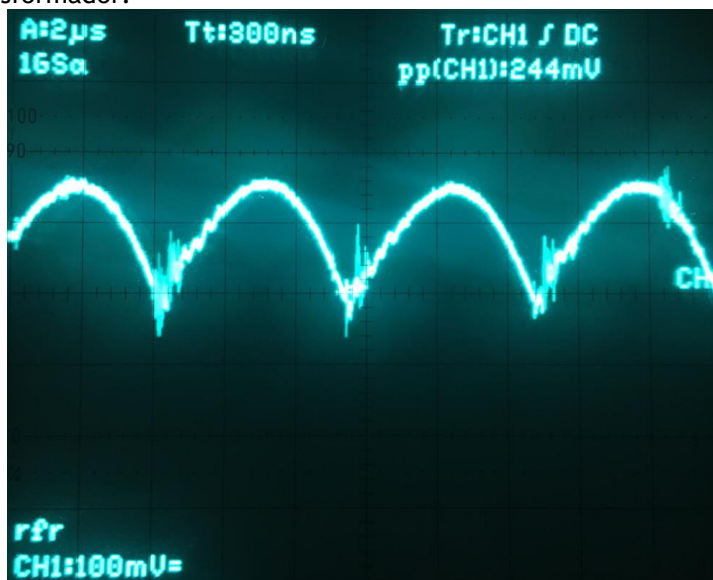
Figura 89 - Corrente nos díodos do secundário em meia carga
