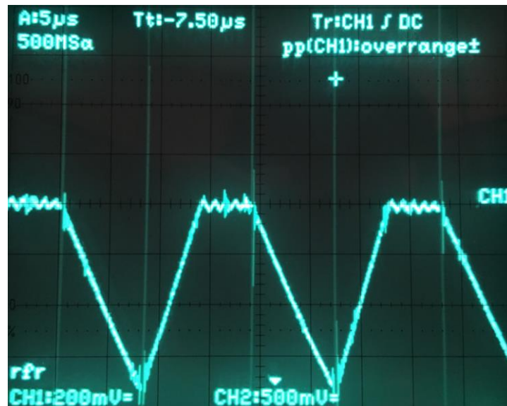
Figura 90 - Corrente inversa na bobine do PFC para 120 VAC em carga máxima
