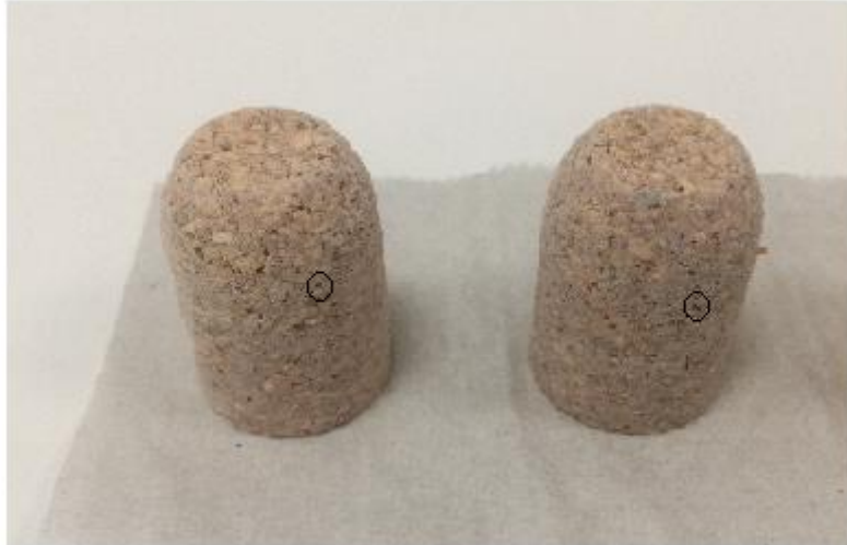
Figura 4.15 - Rolha moldação com poros.
