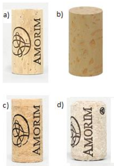
Figura 2.1 - Rolha a) natural, b) colmatada, c) champagne técnica, d) aglomerada
