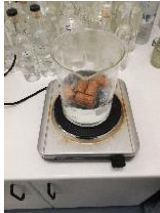
Figura 3.3 - Rolhas durante o teste de fervura
