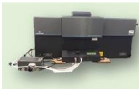
*Figura 10: Equipamento para análise da morfologia das micropartículas: Scanning electron microscopy (SEM)*
