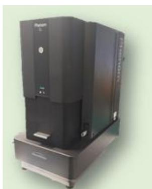
*Figura 11: Equipamento para análise da distribuição de tamanho das micropartículas - Coulter Counter-LS 230 Particle Size Analyzer (granulometria laser)*
