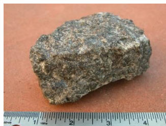
Figura 3.10: Material usado no packed bed (gabro) [32].
