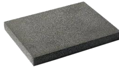
Figura 3.12: Material de isolamento térmico de Foamglass [34].
