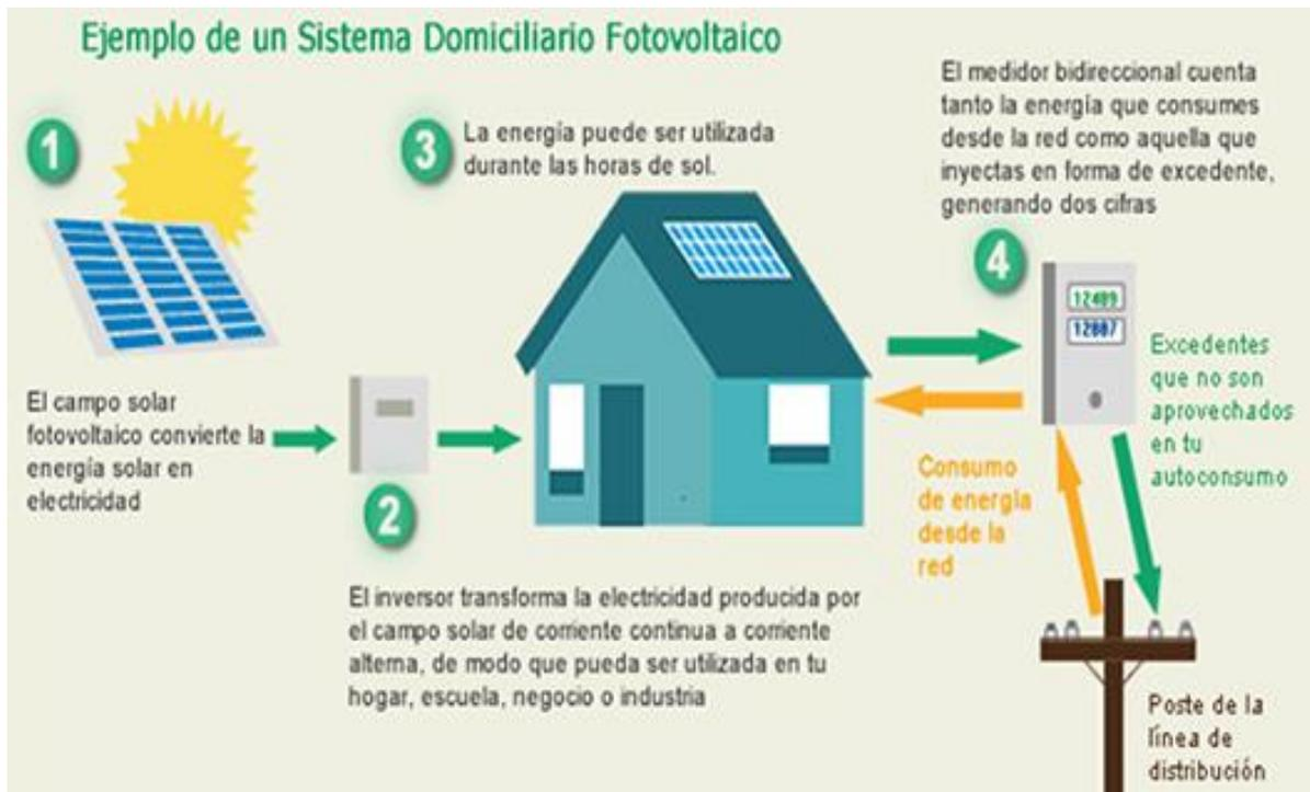
*Ilustración No. 15: Ejemplo de un Kit Solar Fotovoltaico para una residencia sin baterías, On Grid*
