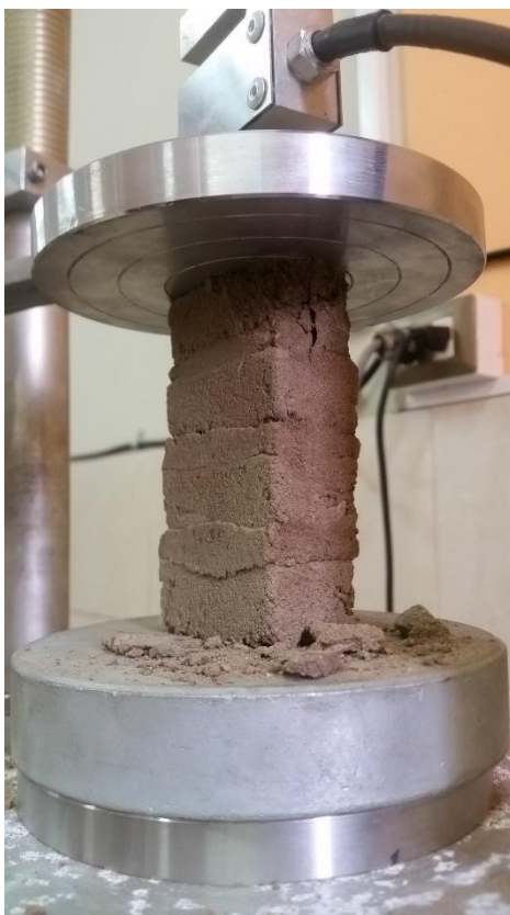
Foto N° 16 Primeras grietas en prototipo de pila de adobe
