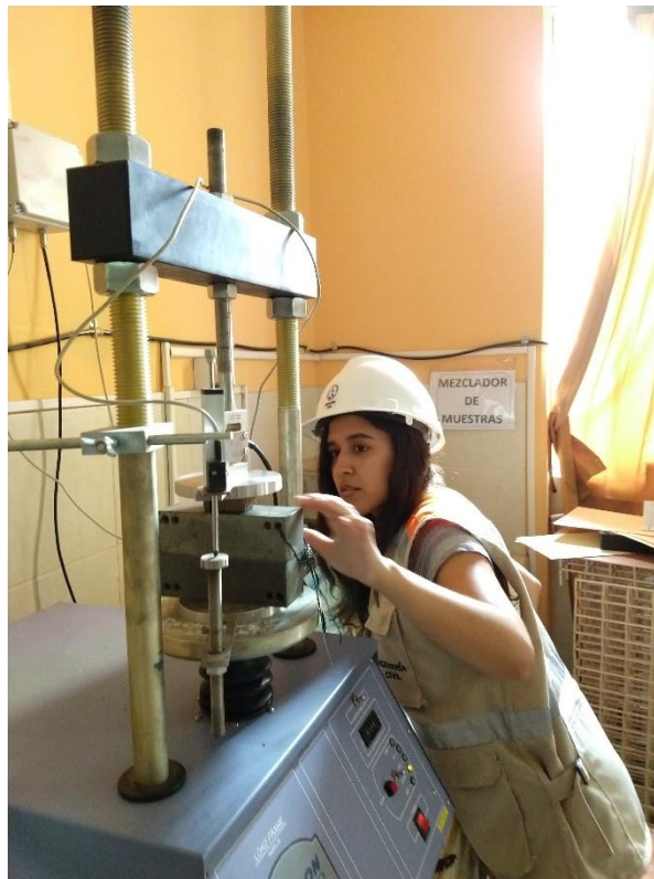
Foto N° 13. Instalación de bloque de adobe para ensayo a compresión
