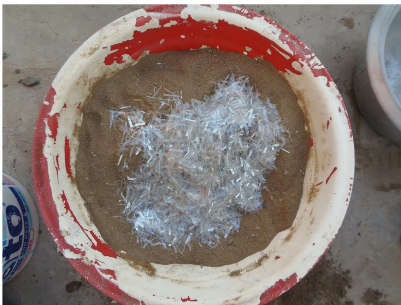
Foto N° 7. Materiales listos para la mezcla
