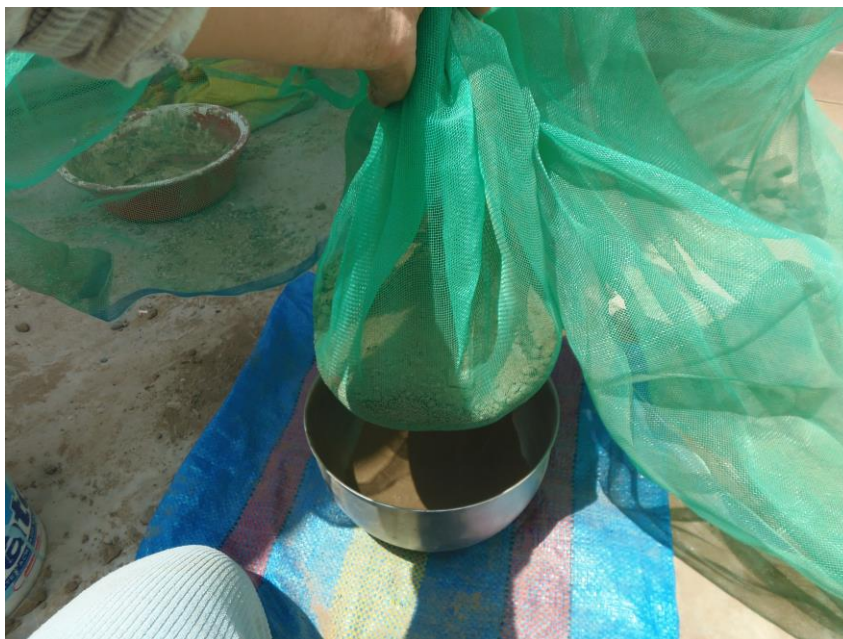
Foto N° 6. Procedimiento de cernido de adobe pulverizado
