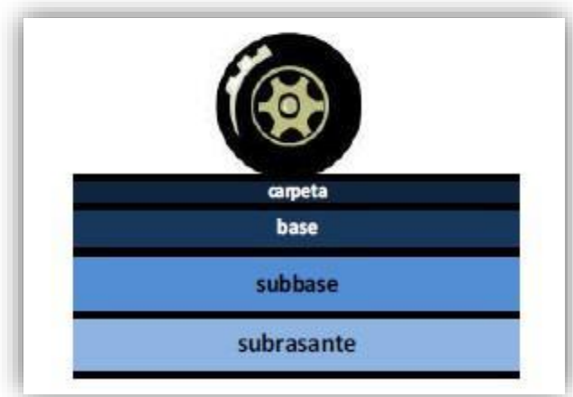
Figura 1. Paquete estructural de un pavimento
