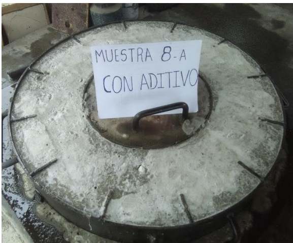
Figura A.8 Muestra de concreto premezclado con y sin aditivo en el ensayo de fisuración
