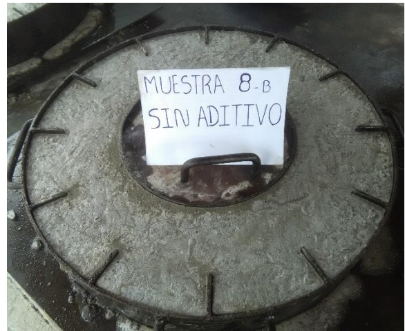
Figura A.8 Muestra de concreto premezclado con y sin aditivo en el ensayo de fisuración
