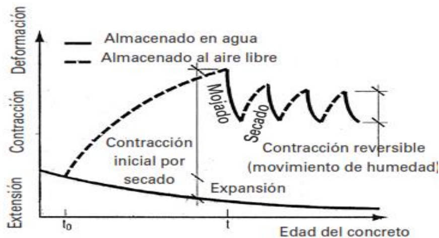
Figura 2.12 Contracción y extensión del concreto según el tipo de curado
