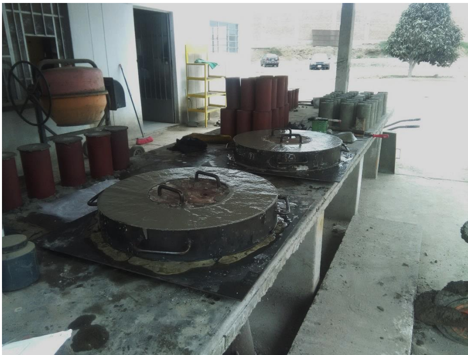
Figura A.7 Ensayo de fisuración método del ACI (Fuente: Propia)
