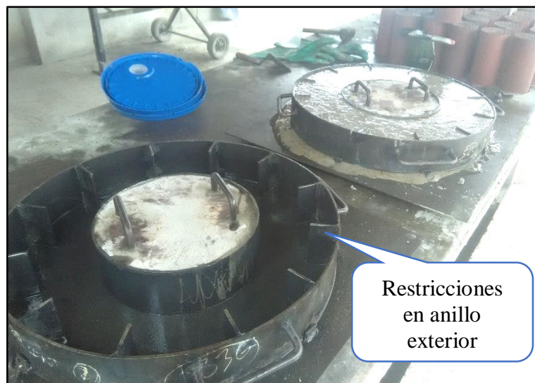
Figura 4.8 Molde tipo anillo para la prueba de fisuración (ACI 544.2R) (fuente: Propia)
