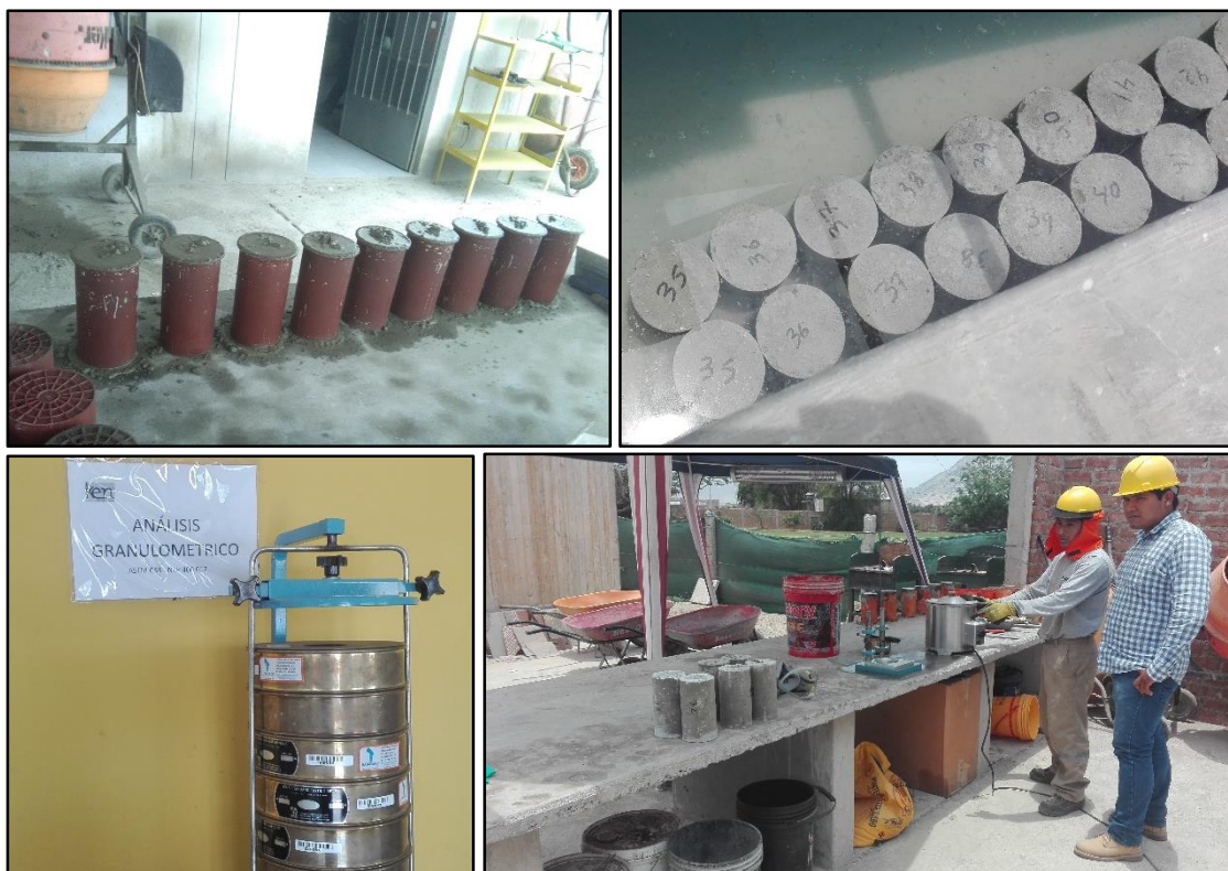
Figura 2.3 Ensayos de control de calidad del concreto premezclado
