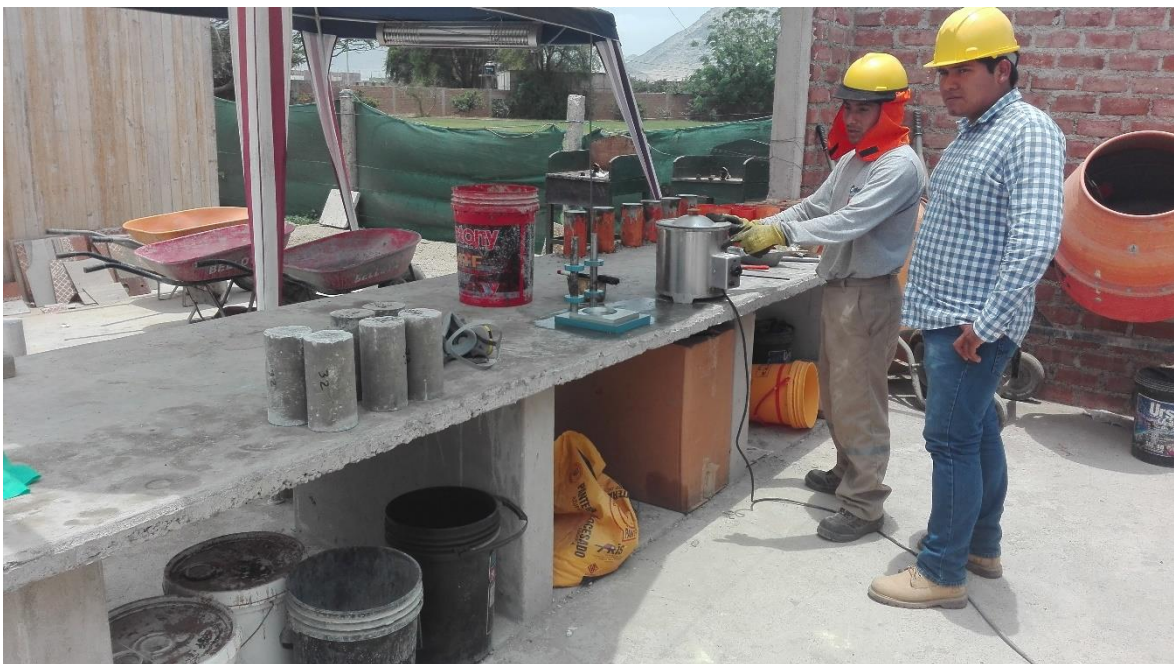
Figura A.6 Ensayo de peso unitario a diferente porcentajes de aditivo (Fuente: Propia)
