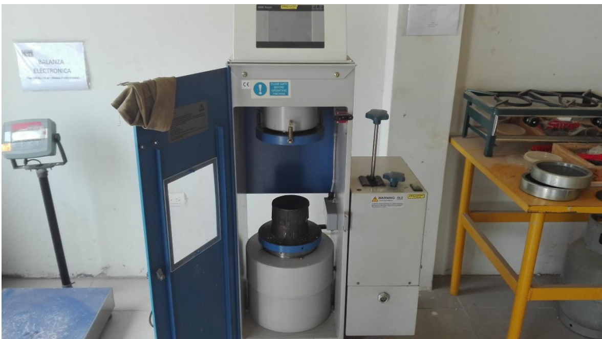
Figura A.11 Ensayo de resistencia a la compresión para muestras con diferentes dosificaciones de aditivo y relación agua cemento ( fuelle: Propia )
