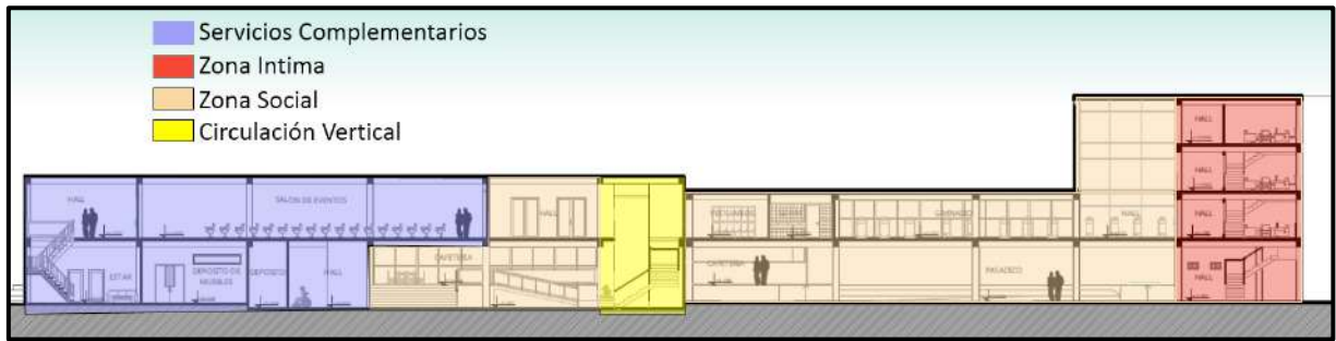
FIGURA N° 33: Zonificación en Corte Transversal 3-3.
