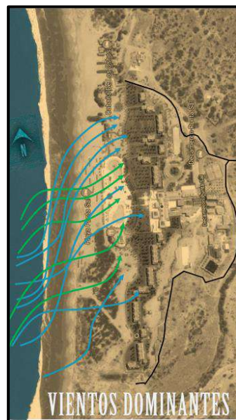
FIGURA N° 11: Ventilación del Hotel Decamerón Punta Sal.
