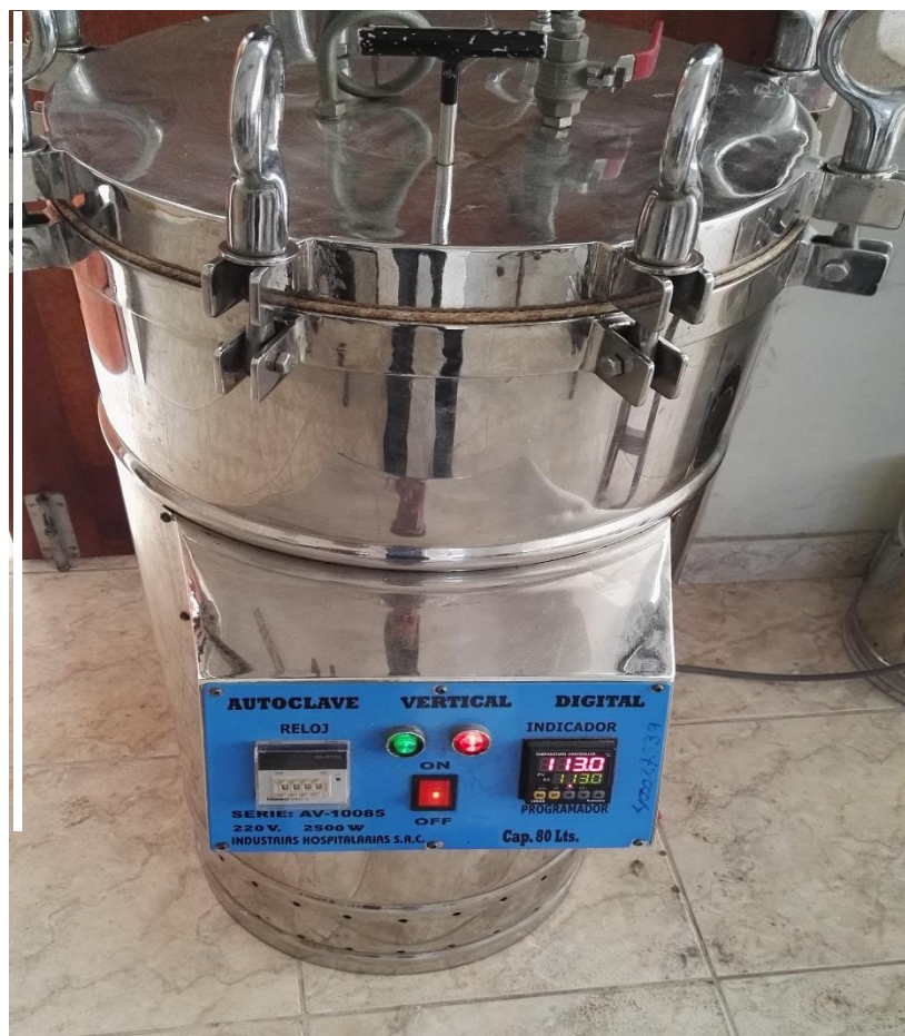
Figura Q. Esterilizado de los envases 1Lb Tall con filetes de tilapia y liquido de gobierno
