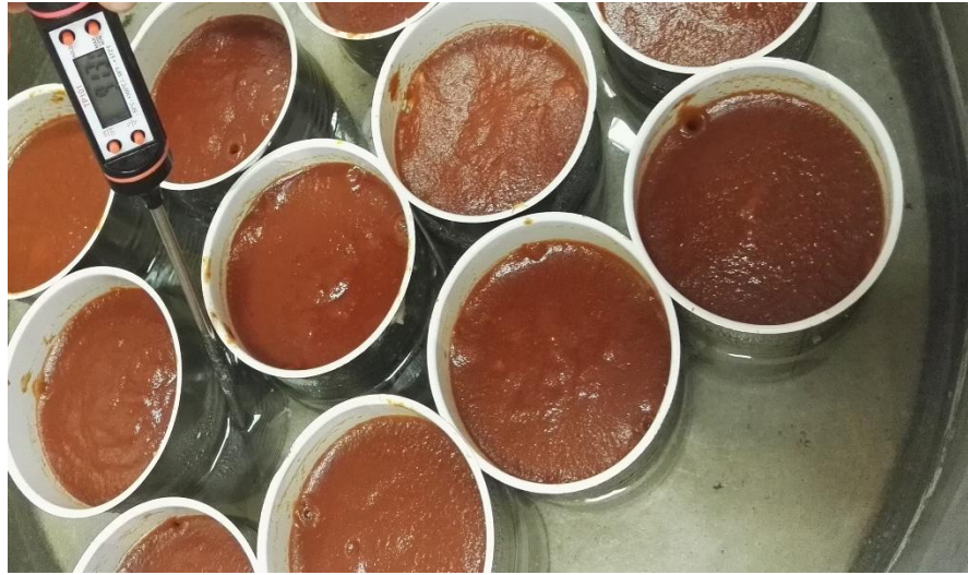
Figura O. Evacuado de los envases 1Lb Tall con filetes de tilapia y liquido de gobierno
