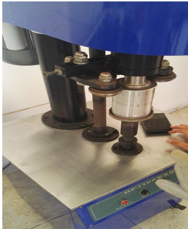
Figura O. Evacuado de los envases 1Lb Tall con filetes de tilapia y liquido de gobierno
