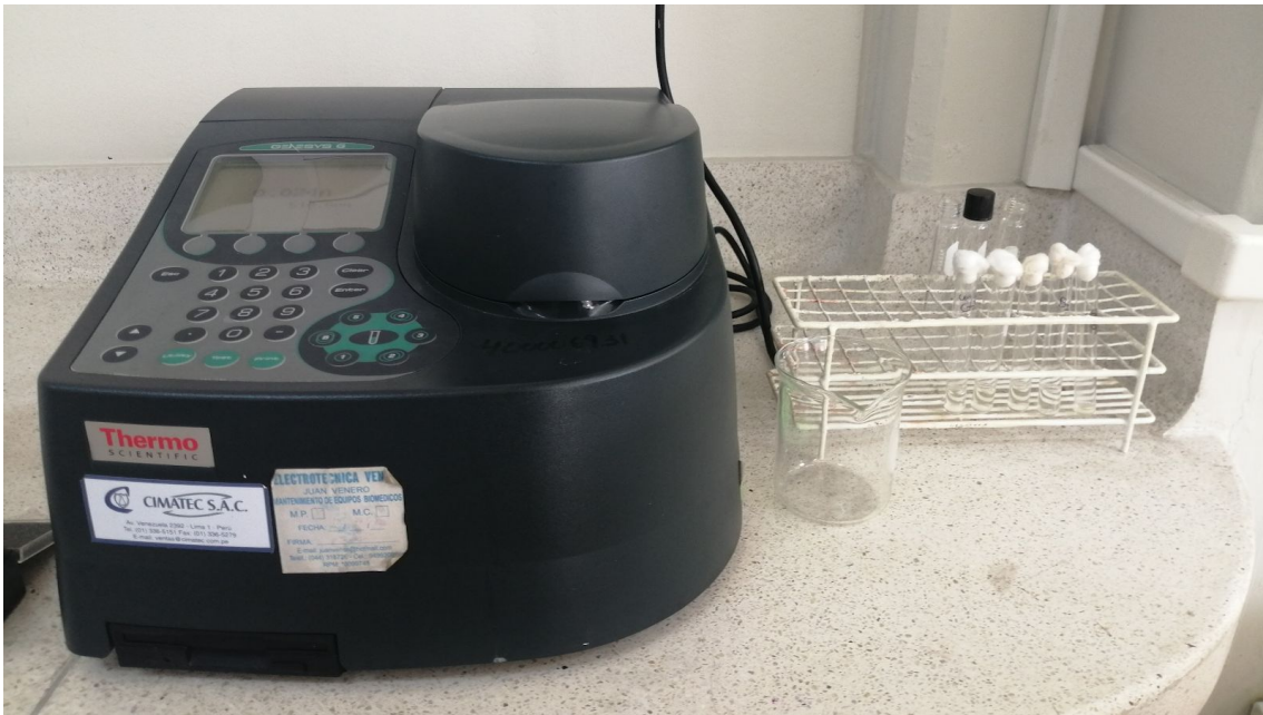
Figura N°45: Espectrofotómetro y tubos de ensayos con muestras obtenidas luego de la incubación de 24 horas. Previa lectura de nivel de turbidez para determinar CMI.
