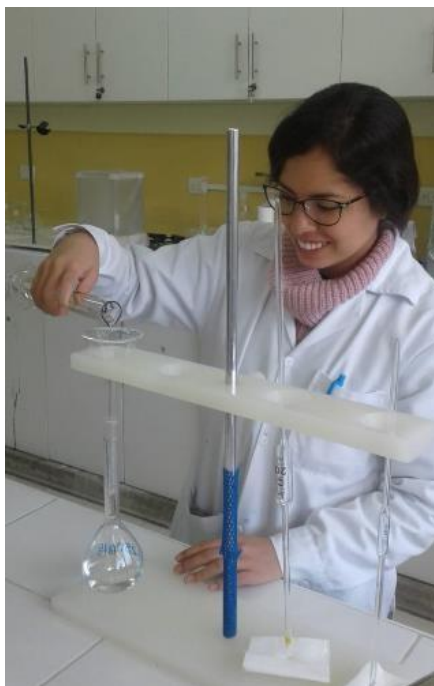
Imagen 2. Preparación de la disolución hidroalcohólica ( \text{CH}_3\text{OH}_{(ac)} al 50%)
