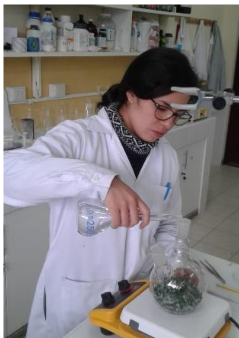
Imagen 10. Mezcla de la disolución hidroalcohólica con las hojas de Eucalyptus globulus Labill
