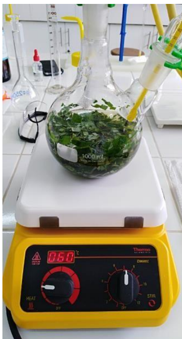
Imagen 11. Extracción por destilación a reflujo de Eucalyptus globulus Labill
