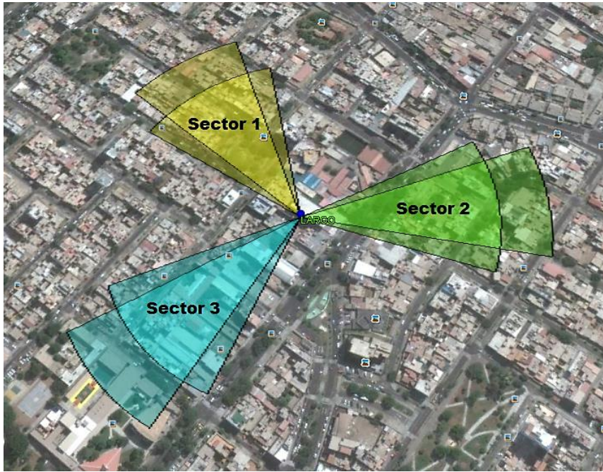
Figura N° 3.2. Sectorización 2G de la Estación Movistar Larco en la Urb. San Andrés
