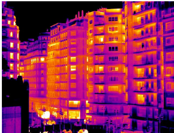
Figura 8: Imagen termográfica de una edificación
