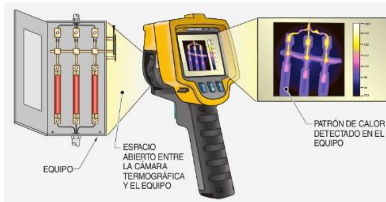
Figura 9: Imagen de cámara termográfica detectando patrones de calor
