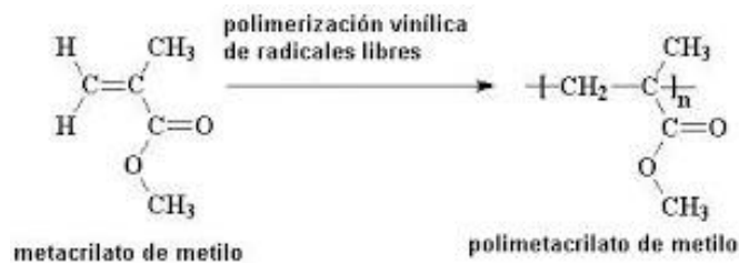
Figura 5: Estructura química de polimetacrilato de metilo
