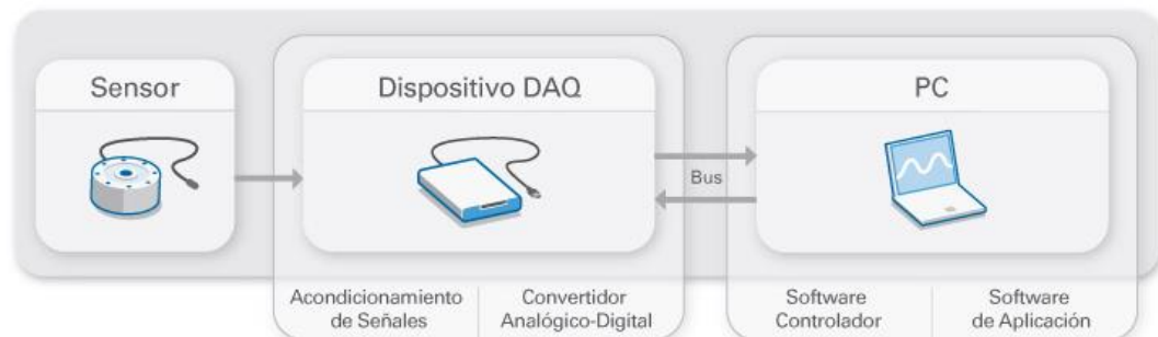
Ilustración 2 Partes de un Sistema DAQ.
