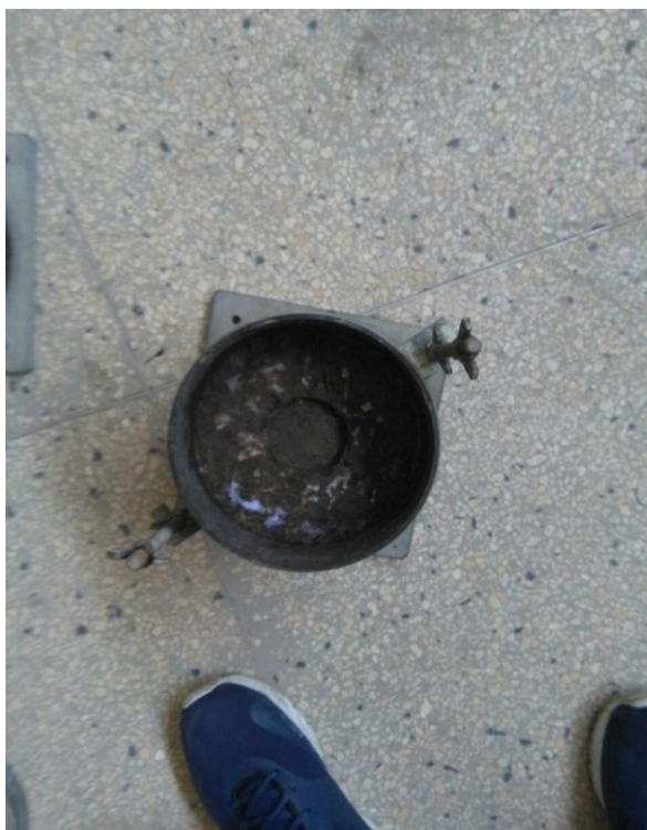
Figura 86. Muestra con 16% de emulsión asfáltica. Después del ensayo de CBR
