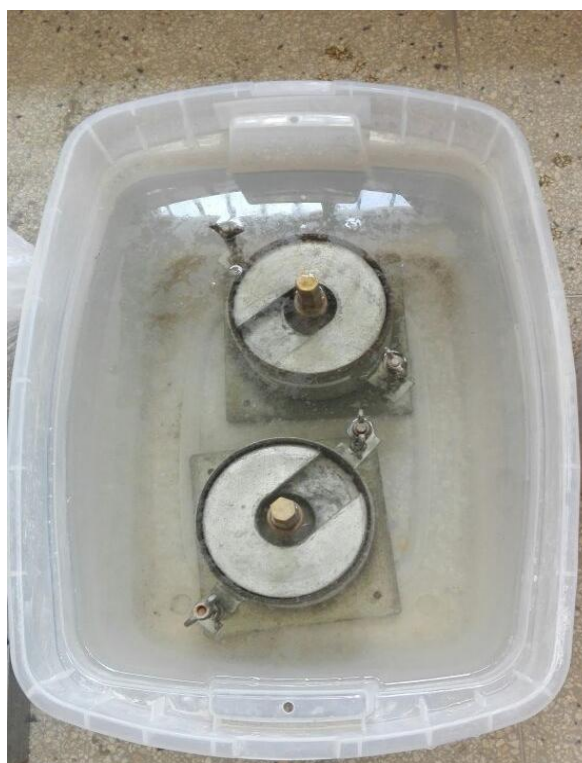
Figura 74. Proceso de saturación de moldes preparados por 96 horas
