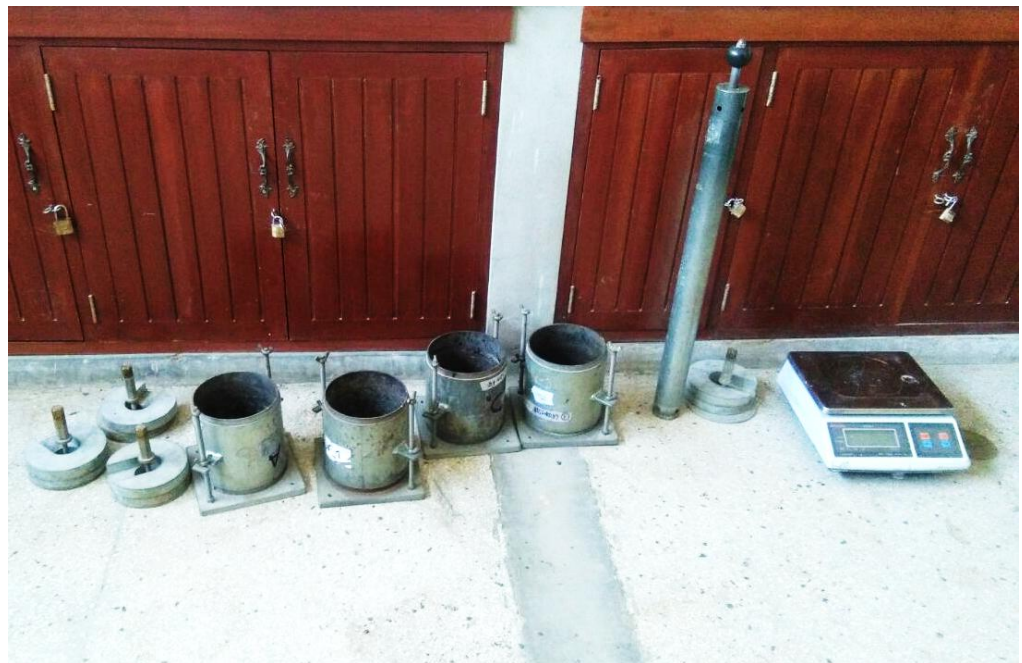
Figura 62. Materiales utilizados para el ensayo de CBR
