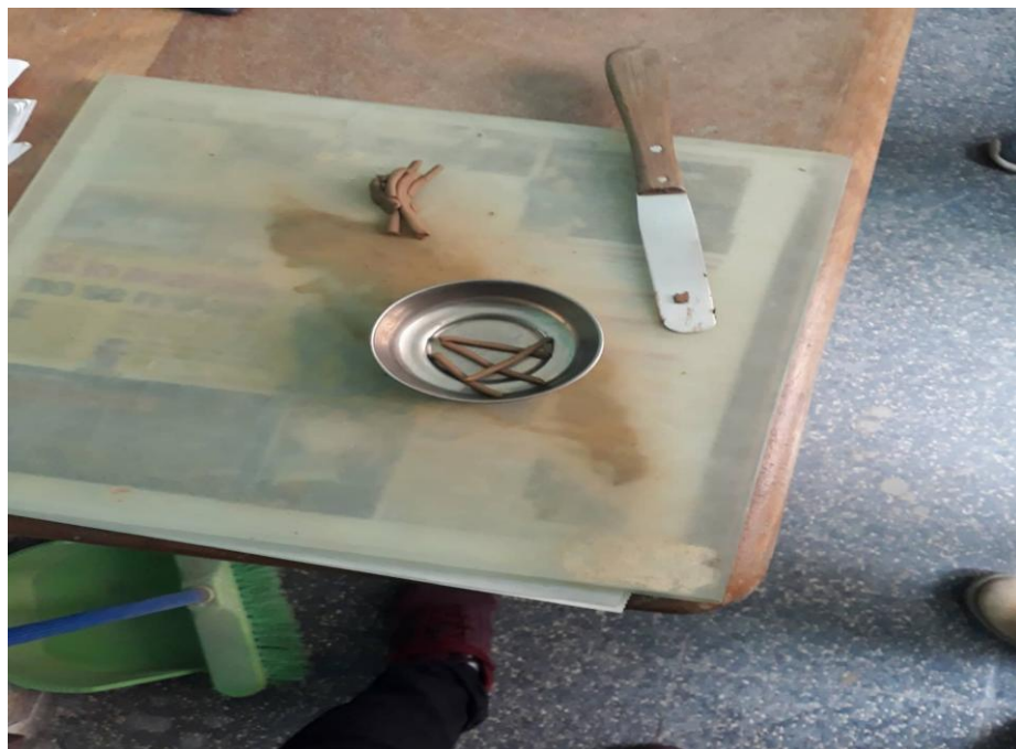
Figura 19. Calculando el (LL) Y (LP), según la Norma ASTM D4318-05
