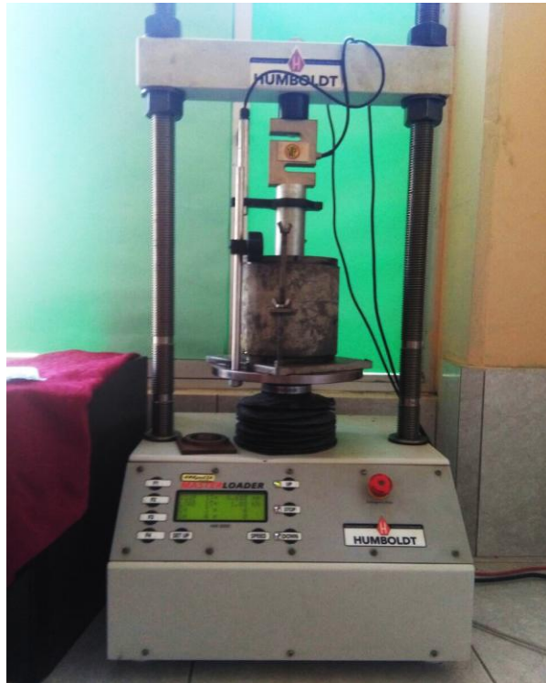
Figura 81. Ensayo de CBR de muestras con emulsión asfáltica
