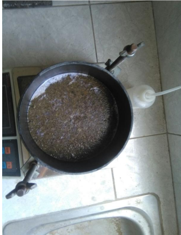
Figura 77. Molde con suelo después de la saturación
