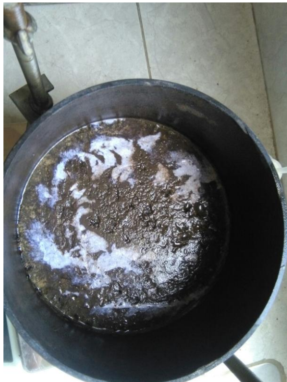
Figura 78. Molde con muestra más emulsión asfáltica después de la saturación
