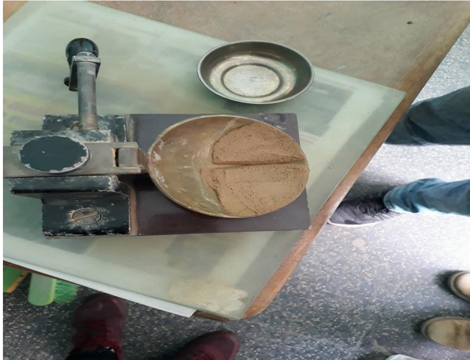
Figura 18. Analizando los Límites de Atterberg en la copa de Casa Grande
