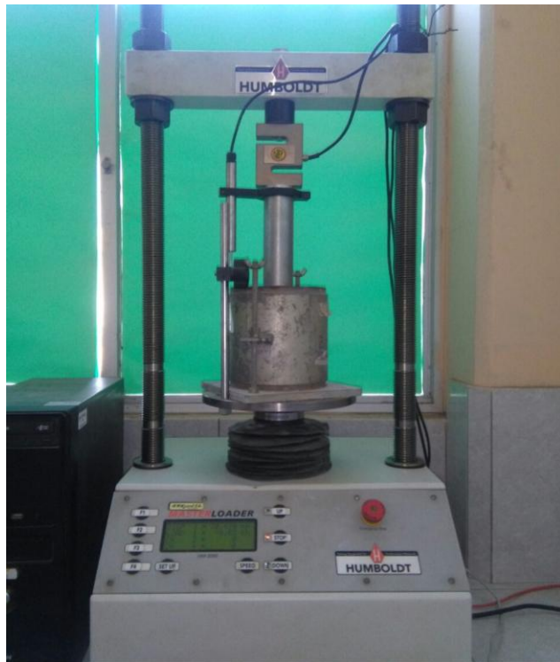
Figura 80. Ensayo de CBR en la prensa HUMBOLDT
