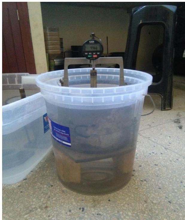
Figura 76. Medición de expansión del suelo en molde de CBR
