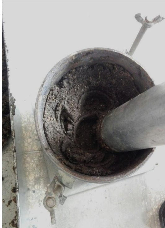
Figura 71. Vista superior de la compactación de suelo con emulsión asfáltica
