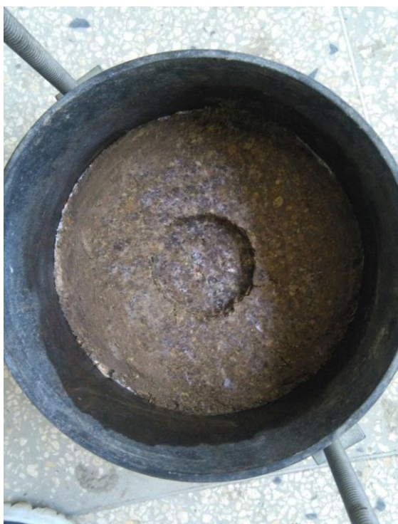
Figura 84. Muestra con 8% de emulsión asfáltica. Después del ensayo de CBR
