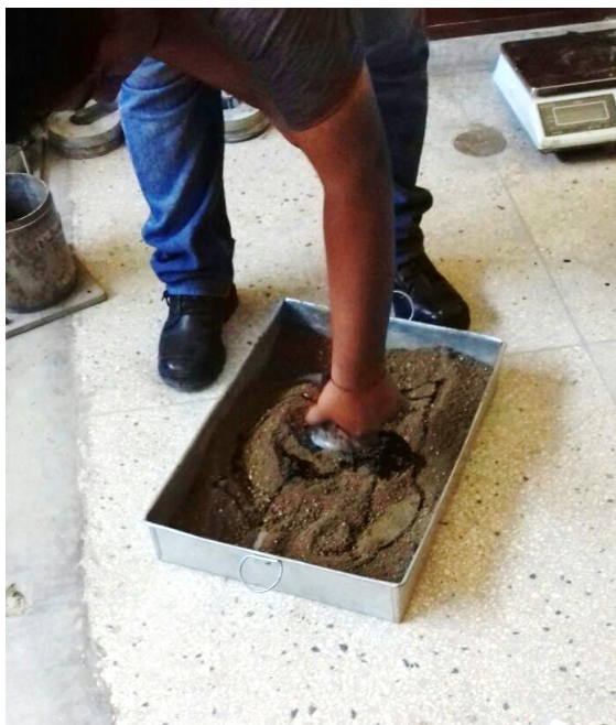
Figura 66. Adición de emulsión asfáltica catiónica a la muestra de suelo
