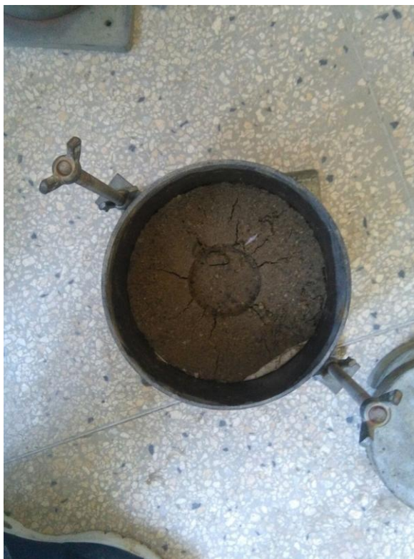
Figura 83. Muestra con 4% de emulsión asfáltica. Después del ensayo de CBR
