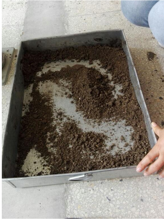
Figura 67. Suelo después de la adición de emulsión y agua
