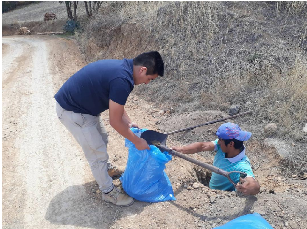
Figura 11. Obtención de nuestro material pétreo y protegidas con bolsas herméticas
