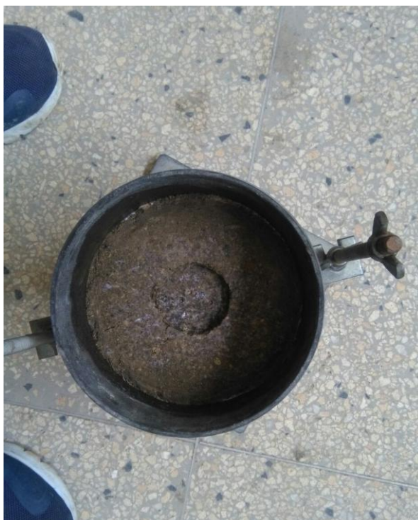
Figura 85. Muestra con 12% de emulsión asfáltica. Después del ensayo de CBR
