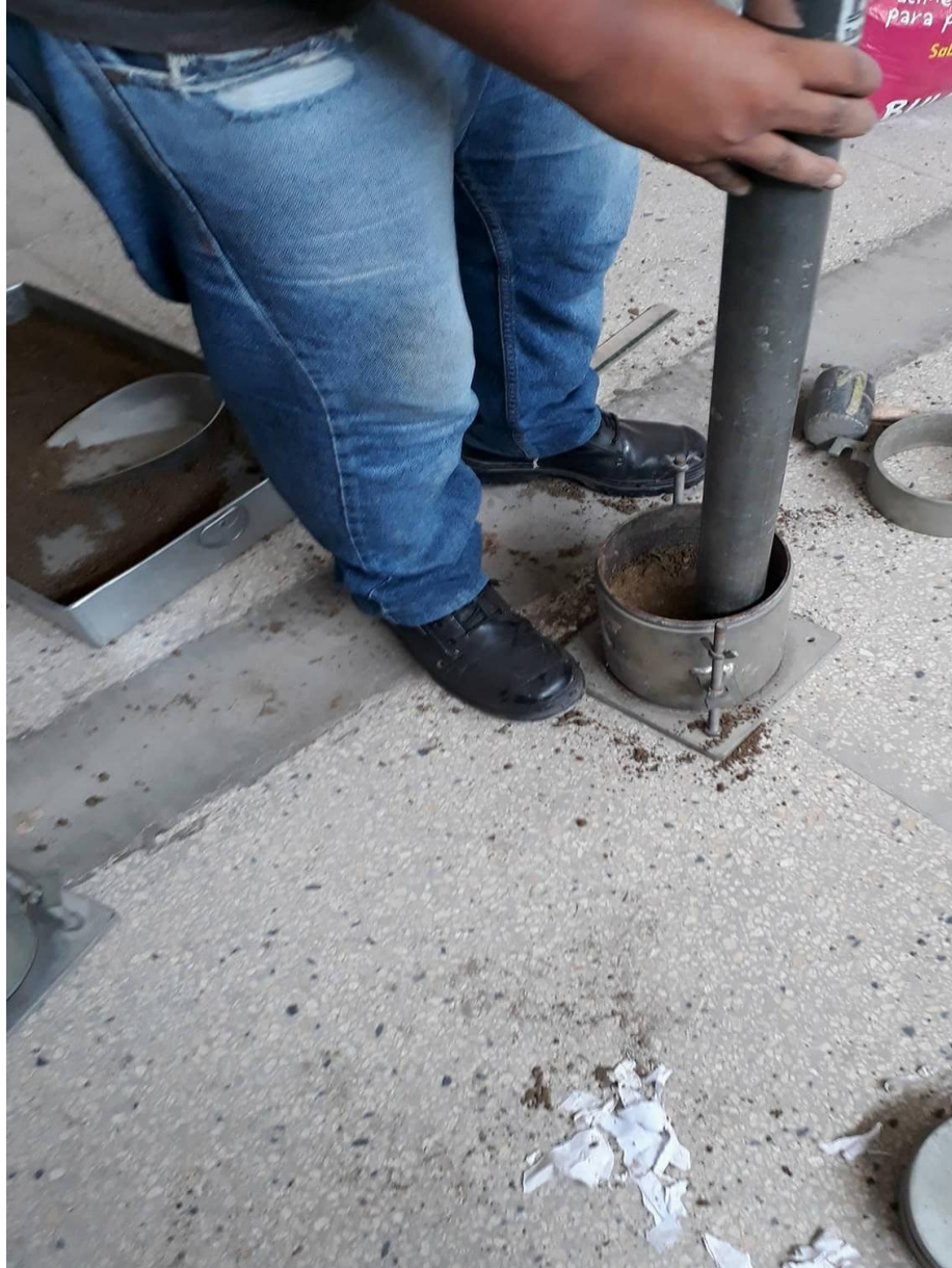
Figura 20. Compactación (Proctor Modificado) Norma ASTM D 1557
