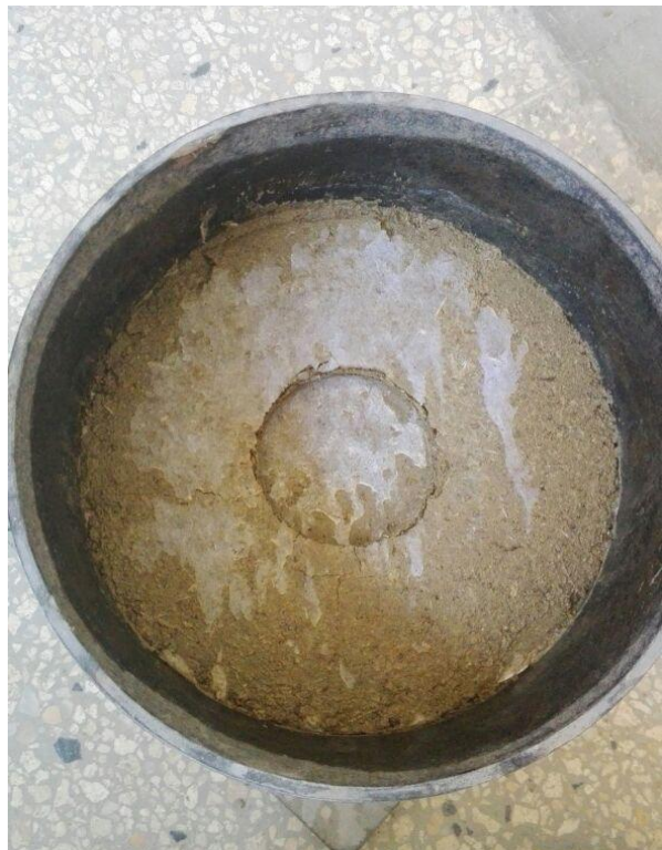
Figura 82. Muestra patrón después del ensayo de CBR
