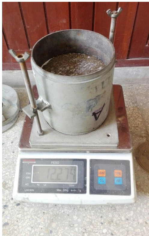
Figura 72. Pesado molde después de la compactación de suelo
