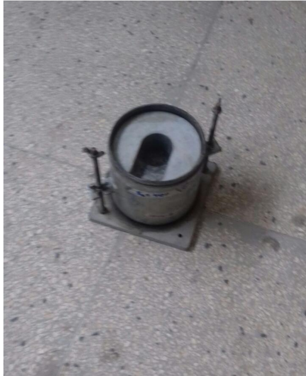
Figura 79. Molde preparado con sobrecargas para el ensayo de CBR
