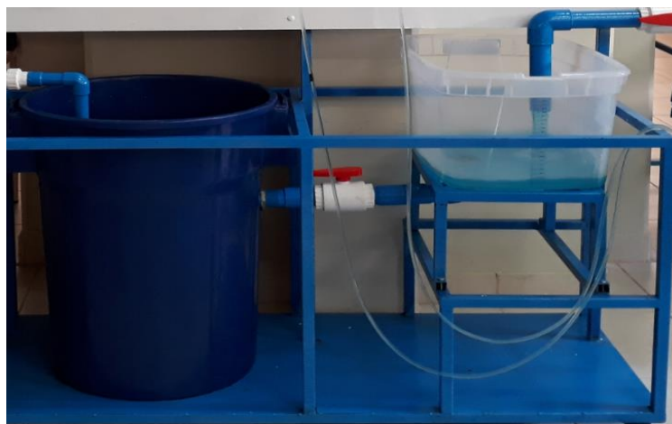
Figura N°33. Medidor de Caudal mediante Válvula de Bola
