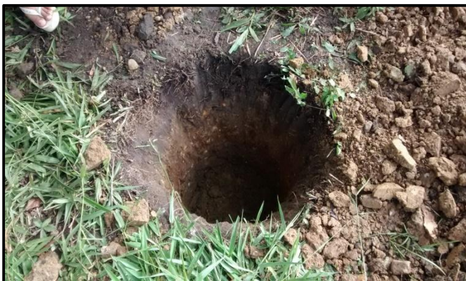
Figura 28. Calicata a una Profundidad de 1.20 m
