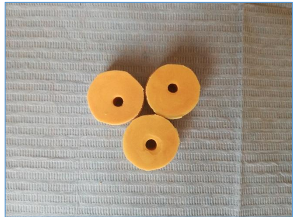
Matriz de silicona donde será colocada la resina Bulk Fill
