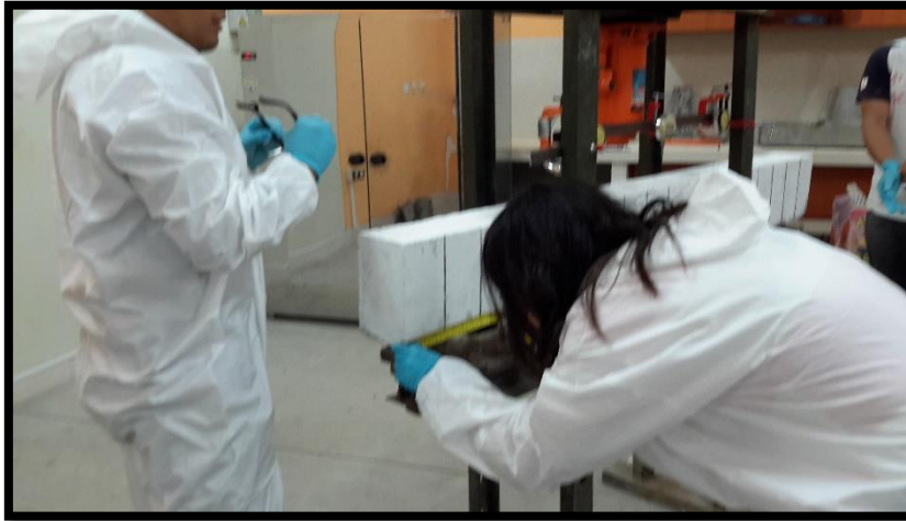
Figura 4.15.- Alineamiento de viga a ensayar
