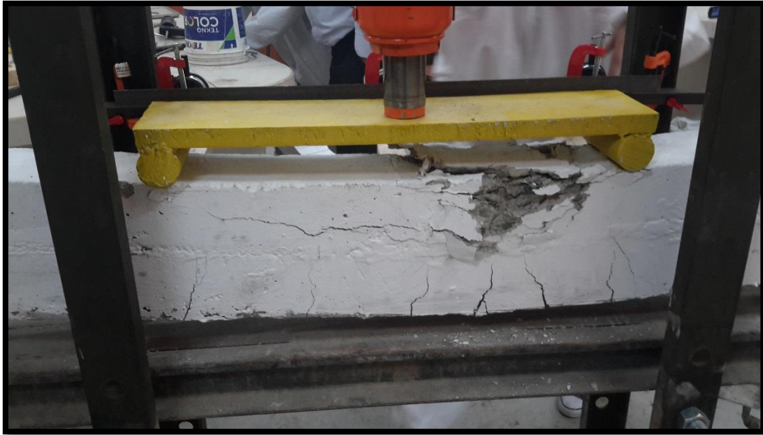
FOTOGRAFIA 9.- Bloque distribuidor de carga
