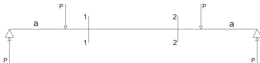
Figura 2.5 Secciones de viga
