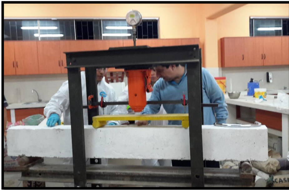
Figura 4.11.- Colocación de bloque aplicador de carga
