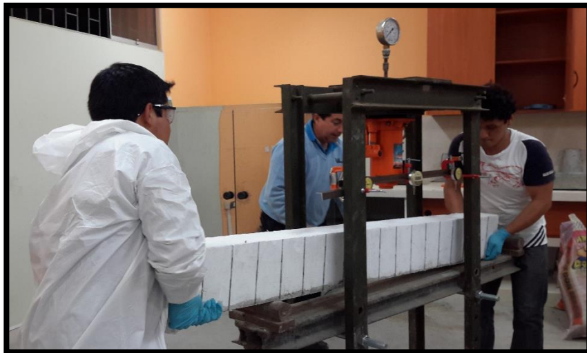
Figura 4.14.- Posicionamiento de viga para ensayo
