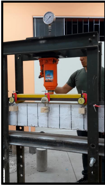
Figura 4.21. Inicio de prueba – Adhesivo sobre eje neutro
