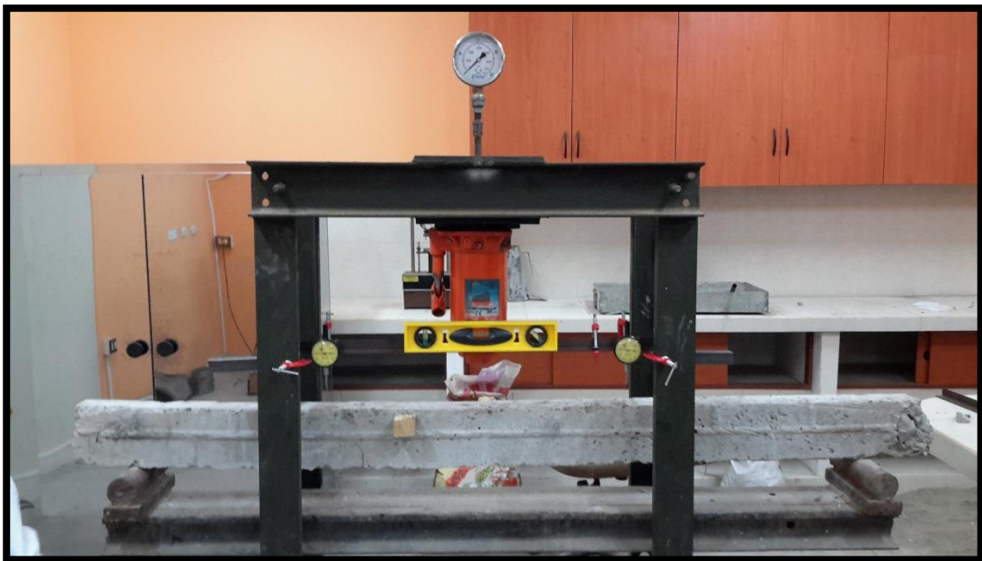
FOTOGRAFIA 12.- Instalación de viga de prueba
