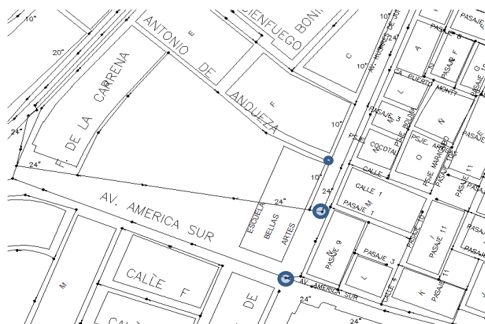
Figura N° 51: Plano de la red de alcantarillado
