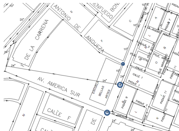
Figura N° 16: Plano de la red de alcantarillado
