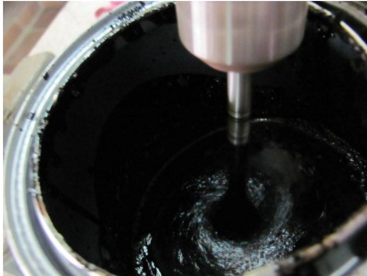
Figura N° 22 Mezclado del asfalto - caucho – azufre.
