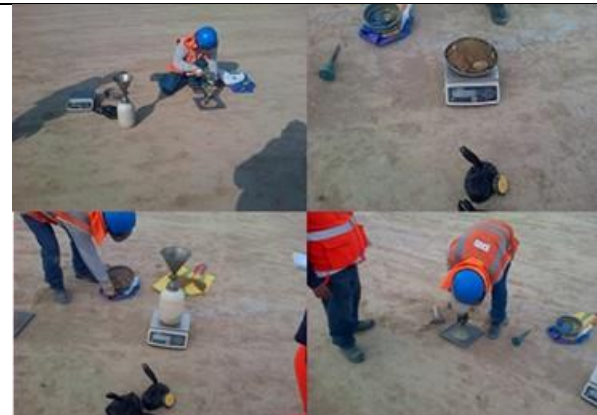
Verificación de niveles de capa de afirmado y ensayos de densidad de campo
