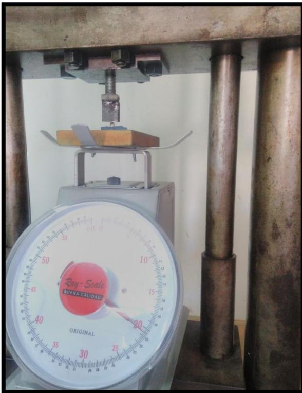
Se acopló una balanza a la máquina para medir la fuerza aplicada en Kg.
