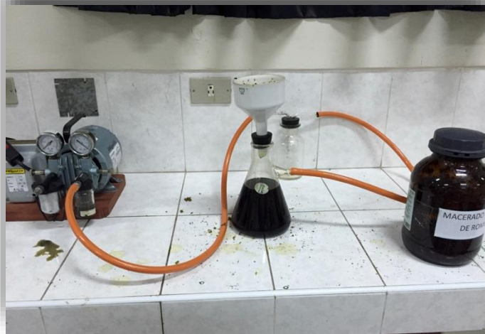
17. Equipo de extracción
