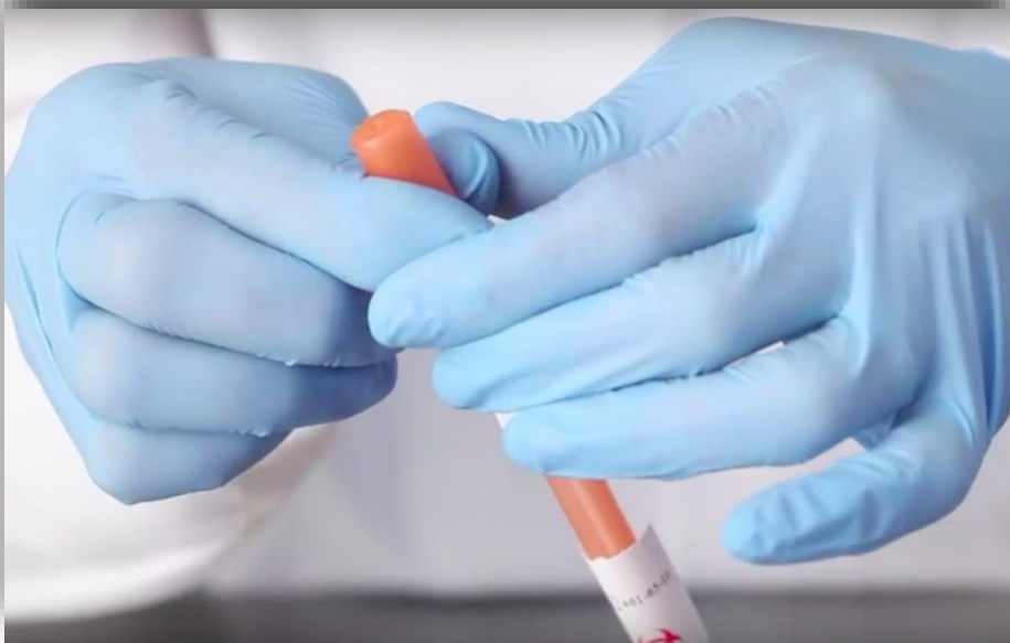
6. Apretando (una sola vez) la ampolla en la parte superior de KWIK-STIK™
