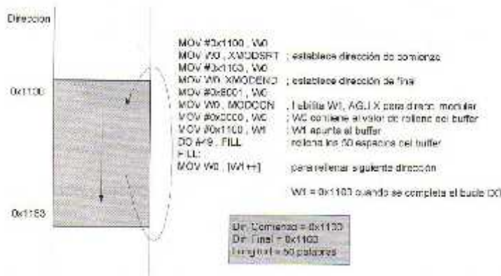
Ilustración 37 Ejemplo de exploración del buffer incremental con direccionamiento modular (ANGULO USATEGUI, 2008)
