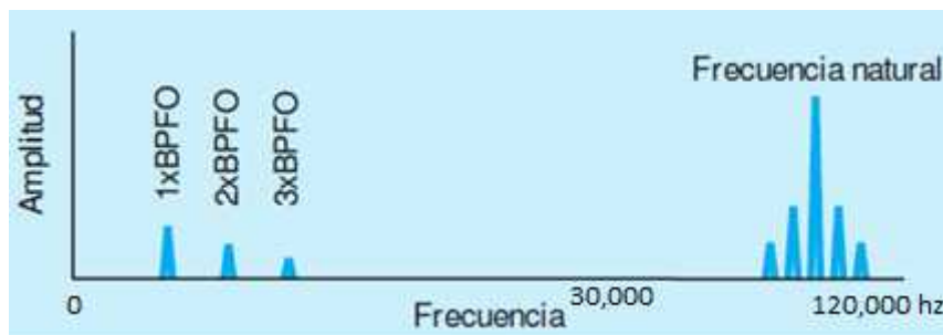
Ilustración 22. Espectro estándar (espectro con ruido aleatorio). (SINAIS INGENIERÍA DE MANTENIMIENTO, s.f.)
