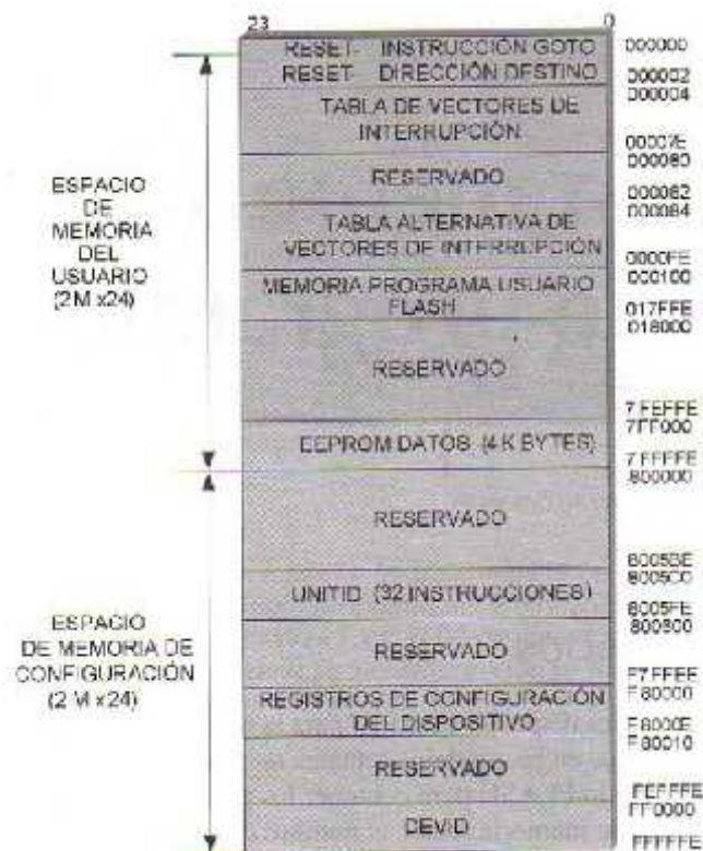
Ilustración 39 Distribución del espacio de direcciones de la memoria de programa para un dsPIC30F. El tamaño de la FLASH y la EEPROM depende del dispositivo específico que se trate. (ANGULO USATEGUI, 2008)
