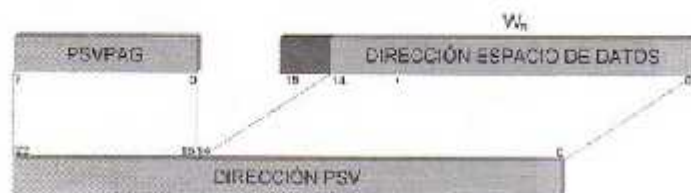
Ilustración 34 Formación de la dirección efectiva PSV a partir de los 8 bits del registro PSVPAG y los 15 de menos peso del registro Wn que contiene la dirección del espacio de la memoria de datos. (ANGULO USATEGUI, 2008)
