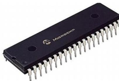
Fig. N° 3.23: Microcontrolador PIC 16F877A
