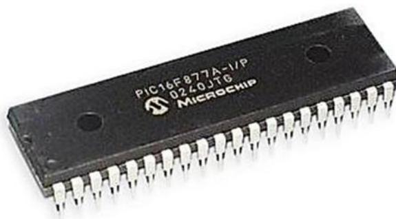
Fig. N° 2.31. Microcontrolador PIC 16F877A
