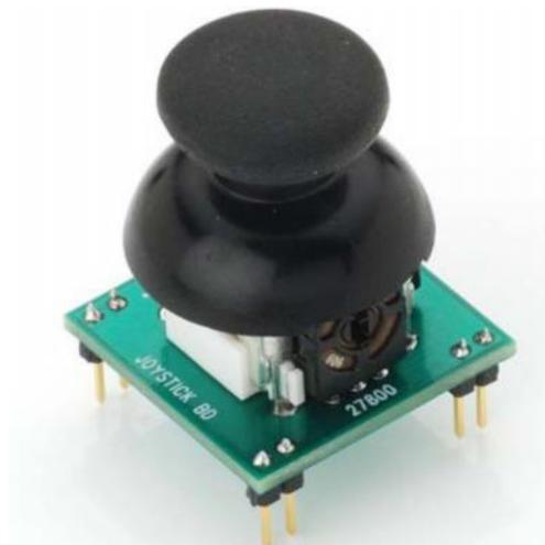
Fig. 3.24: El joystick de 2 ejes #27800
