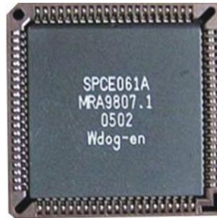
Fig. N° 2.29. Microcontrolador SPCE061A
