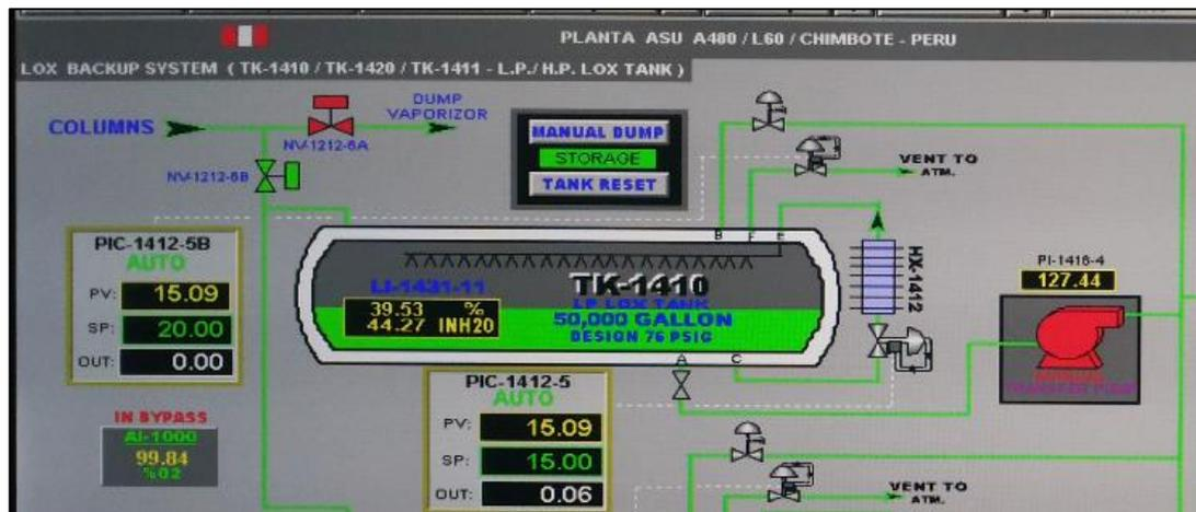
Figura 54: Tanque de almacenamiento LOX
