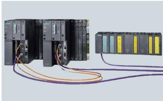
Figura N° 2.7: AS en modo redundante con módulos de seguridad.
