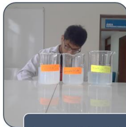
Preparación del látex diluido en 3 concentraciones (4,5, 9, 18 gotas en 250 mL)
