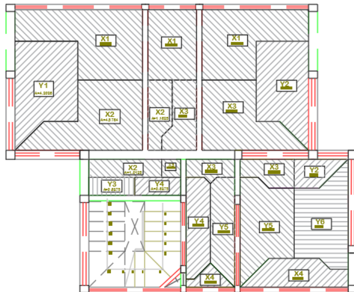
Figura 35. Áreas tributarias para el primer piso
