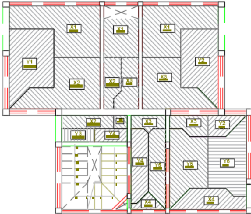
Figura 36. Áreas tributarias para el segundo piso Fuente Propia
