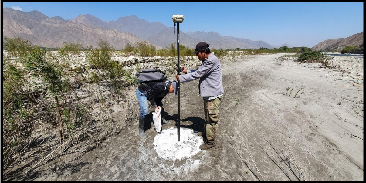
Ilustración 67: Recolección de coordenadas de puntos de control
