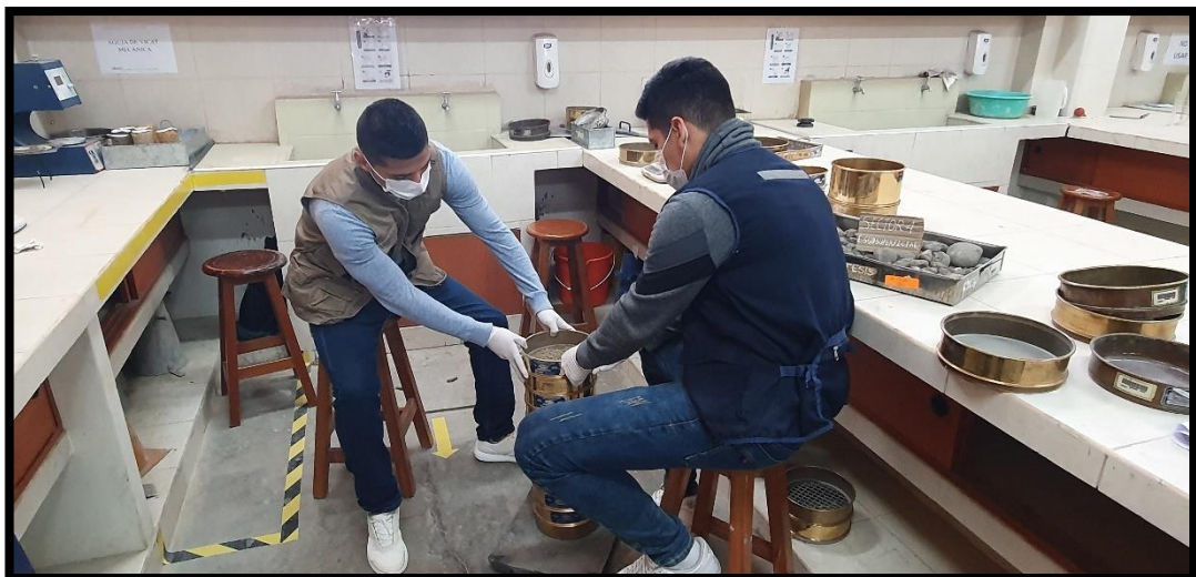
Ilustración 74: Tamizado de Muestras
