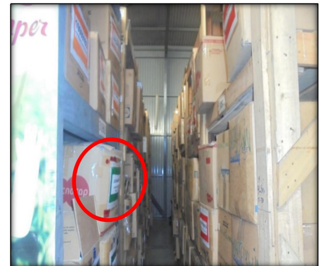
Figura 38. Materiales mal apilados
