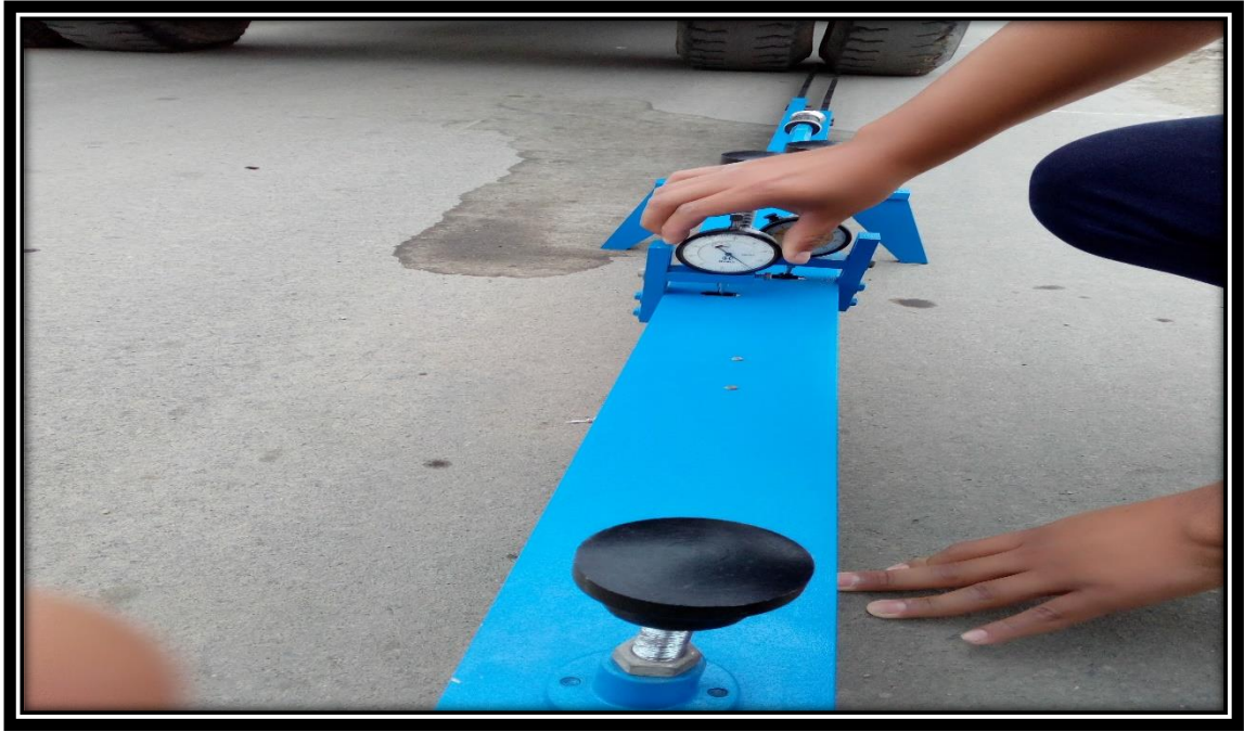
CALIBRACION DE LOS DIALES, HASTA QUE LA AGUJA MARQUE EN EL NUMERO CERO.
