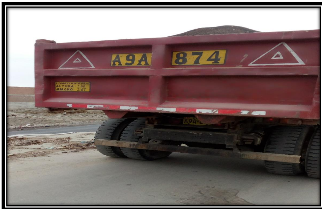
VOLQUETE CARGADO CON 8m 3 DE ARENA GRUESA EN EL EJE TRASERO IGUALMENTE DISTRIBUIDOS EN SUS RUEDAS DUALES Y EQUIPADO CON LLANTAS DE CAUCHO DE 10" X 20".
