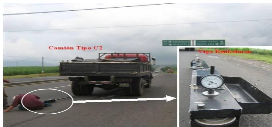
Fig. 3.3 Colocación de la Viga Benkelman, Posición inicial y final.
