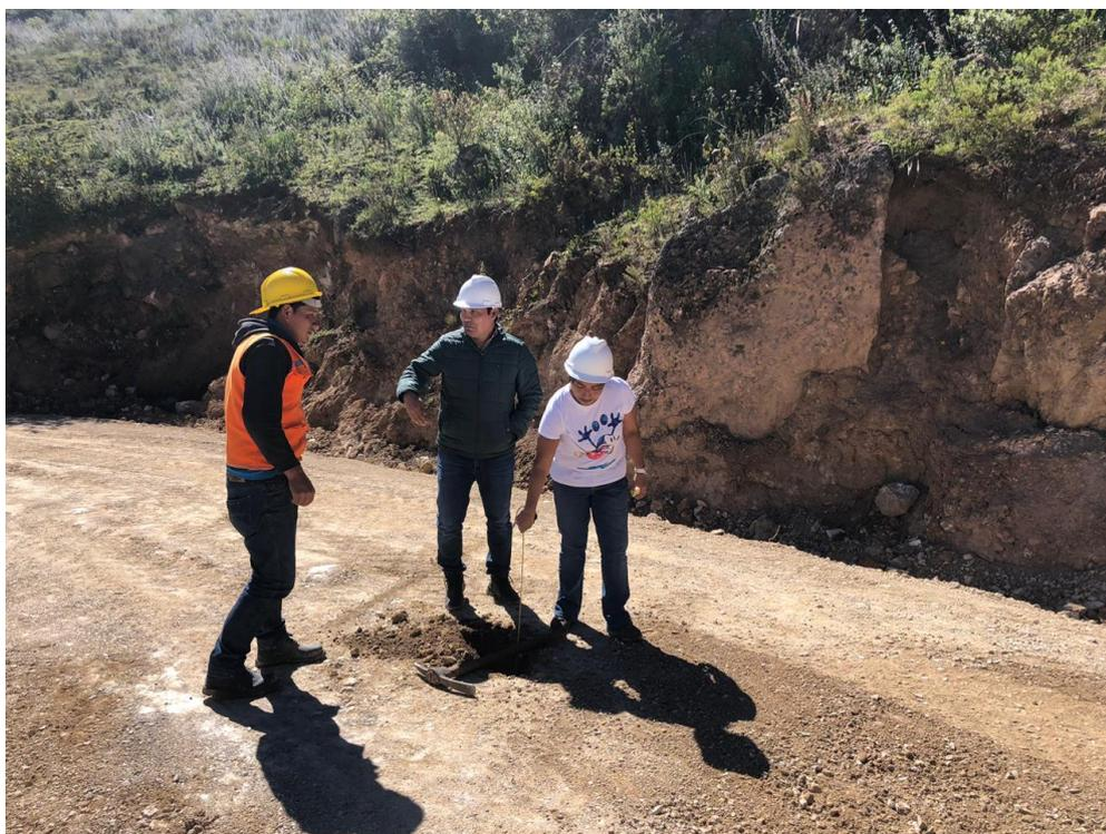
**Fotografía N° 09 : Vista de Tesista tomando muestra de materiales y espesores del pavimento in situ. de la carretera Tayabamba – Ongon.**
