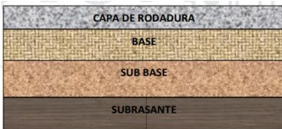
**Figura N° 03 : Componentes estructurales del pavimento**
