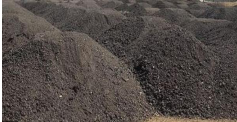
figura 8 Acopio de material fresado
