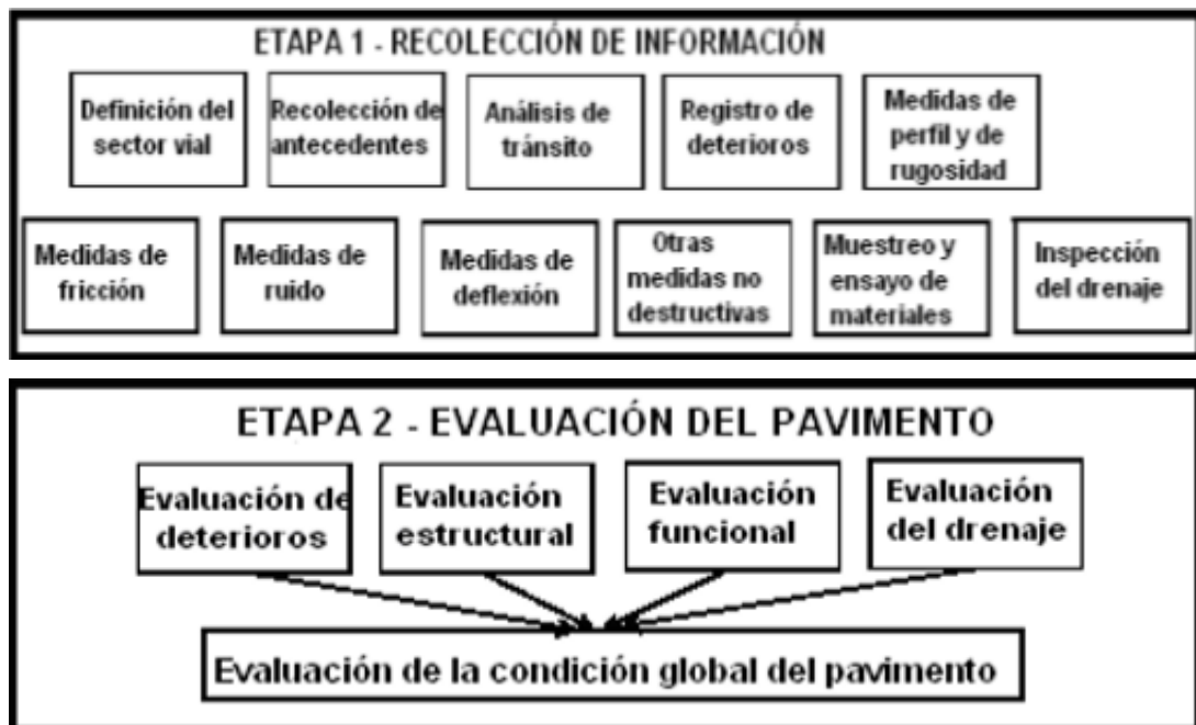
Figura 3. Etapa 1 y 2 Recolección de la información y evaluación del pavimento.
