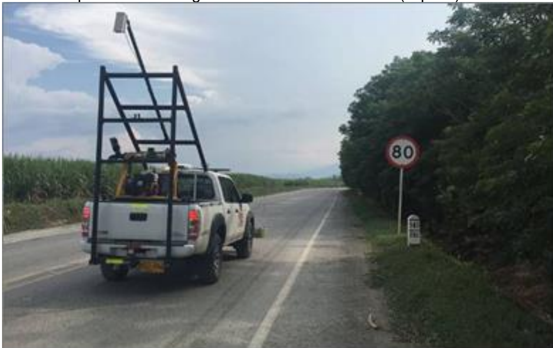
Foto 1. Capturador de Imagen levantamiento de daños (Gipsas)
