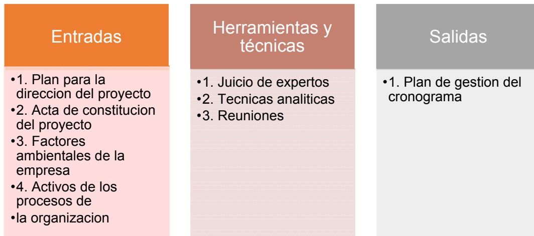
Gráfico 12 Entradas, técnicas y salidas de la planificación de la gestión del cronograma Fuente: Guía PMBOK 6ta edición
